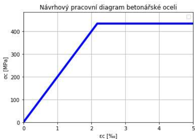
Obr. 72 - Pracovní diagram oceli - graf (Vytvořeno v prostředí Python podle [11])
