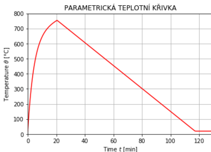
Obr. 3 - Parametrická teplotní křivka, převzato z [1]
