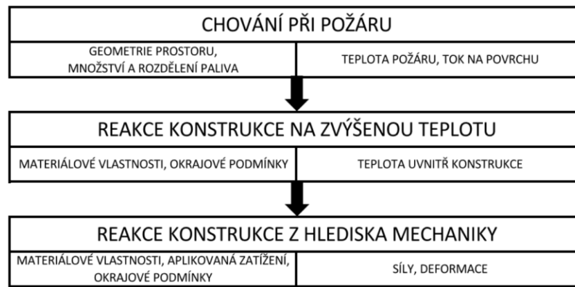
Obr. 11 - šíření nejistoty při simulaci požáru konstrukce – převzato z [13]
