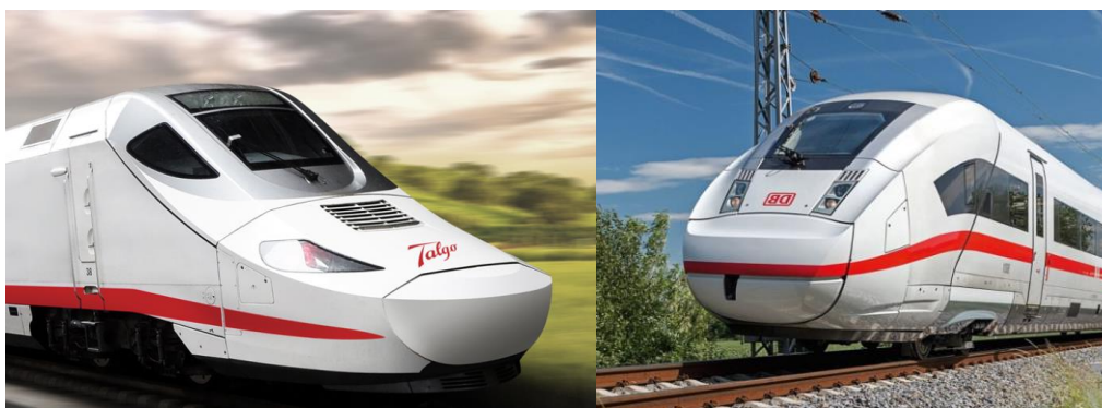
Obrázek 19 – Příklady čelních ploch kokpitů vysokorychlostních jednotek. Vlevo Talgo 250 s konvexním tvarem čela – tzv. „kachní zobák“, . Vpravo ICE4 s konkávním tvarem čela – tzv. „kapkovitý tvar“.
