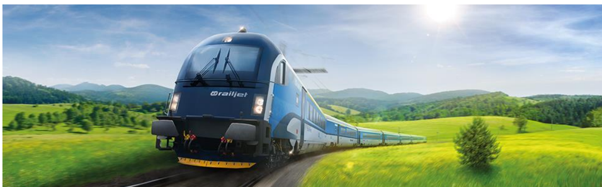
Obrázek 12 - Dálkový vlak Regiojet Českých drah a.s. s v koncepci ucelené jednotky s čelní lokomotivou řady Taurus a hlavovým řídicím vozem. Obrázek z webu Českých drah, [128].
