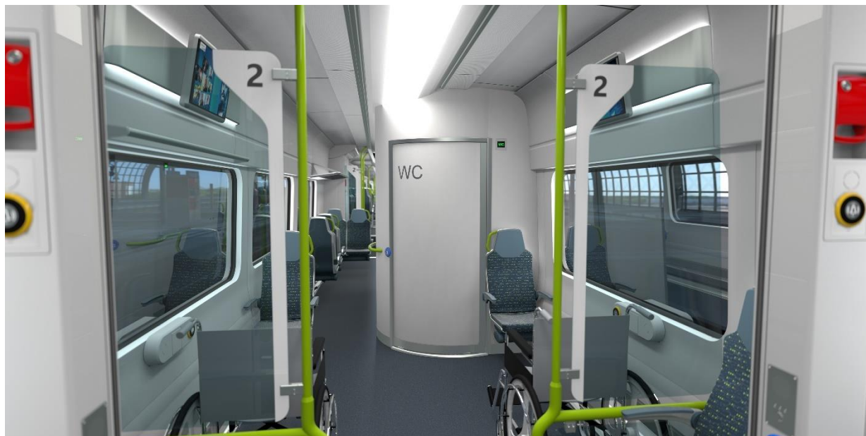
Obrázek 82 - Nízkopodlažní část vozidla s integrací toaletní buňky uzpůsobené pro cestující PRM, platforma Mireo, Siemens Mobility, [126].
