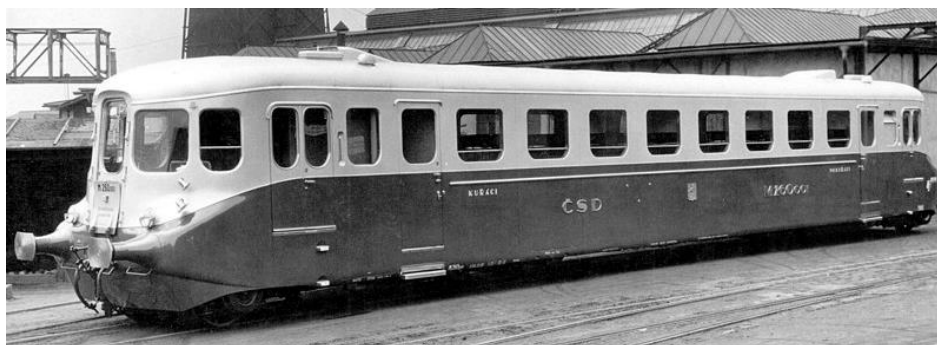
Obrázek 10 - Tovární snímek nově dokončeného vozu M 260.001 Stříbrný šíp v areálu ČKD v Praze-Libni (fotografováno někdy před 14. únorem 1939), [174]. Vozidlo vychází koncepčně ze Slovenské strelý a karosářské práce proudnicového designu Tatry Kopřivnice.
