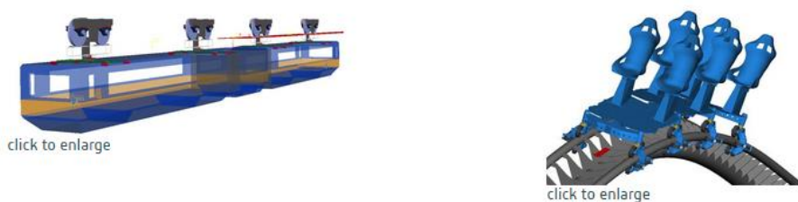
Obrázek 94 - Základní dynamické modely konvenčních železničních vozidel systému Simpack, zleva vozidlo zavěšené typu monorail, vpravo horská dráha, [144].
