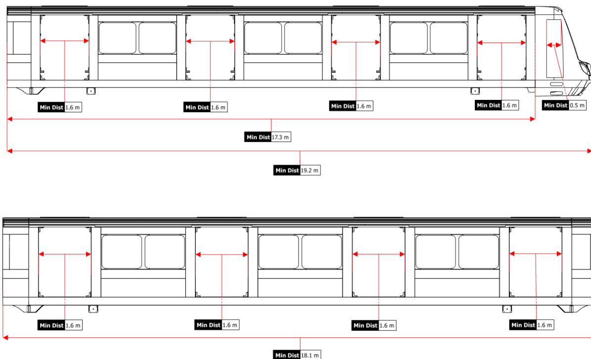
Obrázek 64 - Délky vozidlových skříní a šířky dveřních otvorů u městské jednotky Metro M1 Maracaibo společnosti Siemens Mobility. Horní obrázek představuje hlavové vozidlo, spodní obrázek vozidlo vložené, [126].
