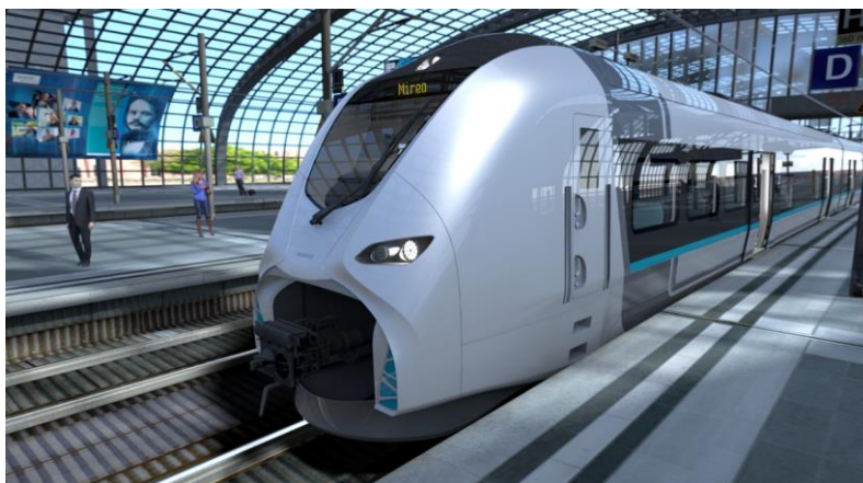
Obrázek 11 - Platforma Mireo společnosti Siemens s možností trakce na vodíkový pohon. Tento princip trakce by mohl nahradit stávající vozidla se spalovacími motory na regionálních tratích a využít čisté energie obnovitelných zdrojů. Vozidlo tak může zajišťovat přepravu na ne-elektrifikovaných tratích, nebo na jejich úsecích, [126].
