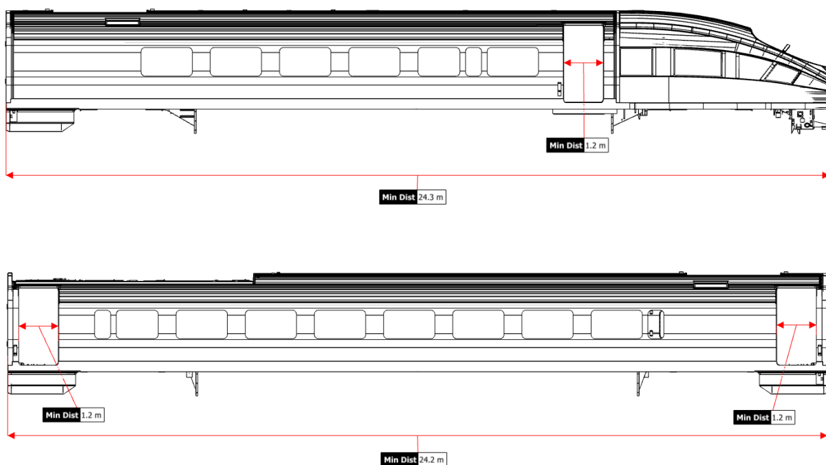
Obrázek 62 - Délky vozidlových skříní a šířky dveřních otvorů u vysokorychlostní jednotky Velaro CRH společnosti Siemens Mobility. Horní obrázek představuje hlavové vozidlo, spodní obrázek vozidlo vložené, [126].
