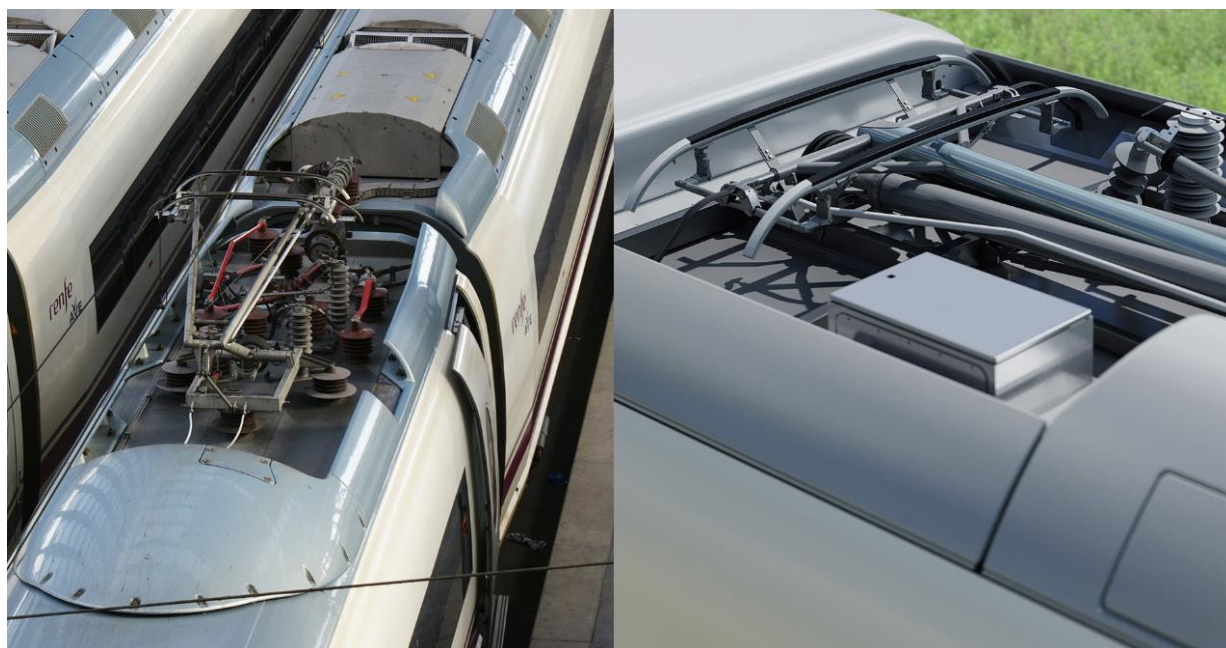
Obrázek 21 - Řešení aerodynamiky pantografu, vlevo Siemens Velaro, vpravo Siemens Velaro Novo, [126].
