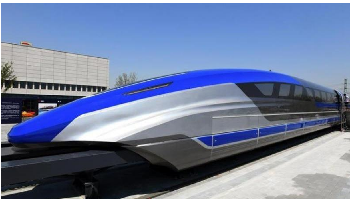
Obrázek 112 - Prototyp čínského MAGLEVu schopný jezdit rychlostí 600km/h, obrázek převzat z webové stránky [176].
