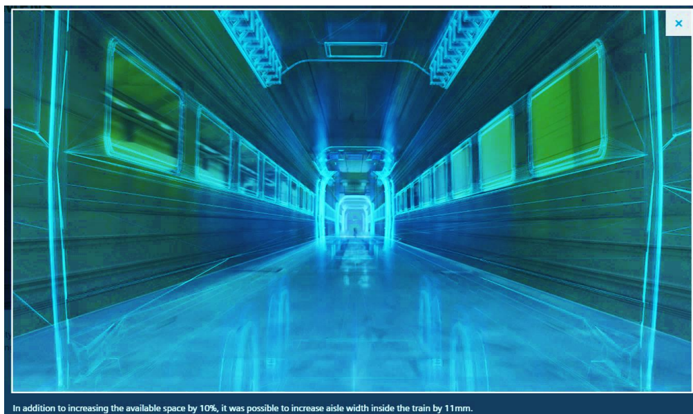
Obrázek 66 – Zvýšením dostupného prostoru o 10% umožnilo rozšířit uličku o 11 mm, Velaro Novo, Siemens Mobility website, [126].
