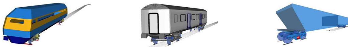
Obrázek 93 - Základní dynamické modely konvenčních železničních vozidel systému Simpack, zleva vozidlo Bo'Bo', osobní vozidlo 2'2' a nákladní vozidlo 2'2', [144].
