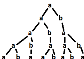
Obrázek 1.2: Ukázka jednotlivých kroků přepisování podle přepisovacích pravidel a \rightarrow ab a b \rightarrow a z počátečního axiomu a .
