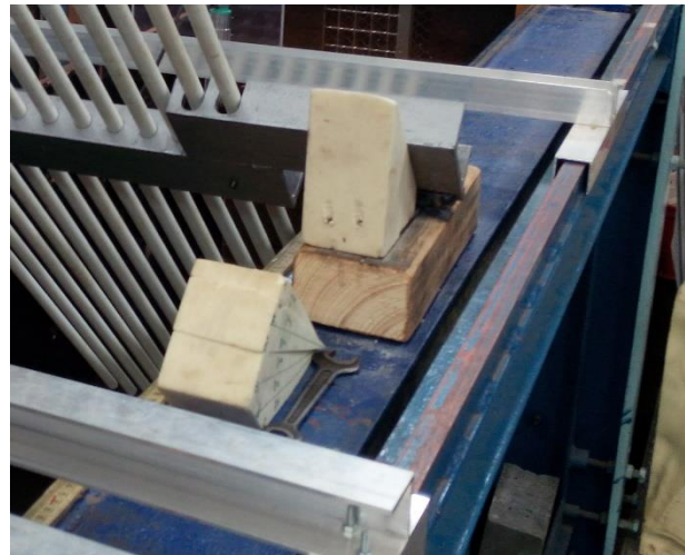
Obrázek 49 - Příložky k nastavení úhlu sklonu česlí
