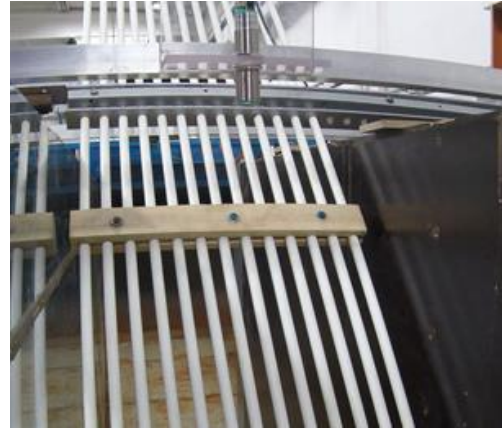
Obrázek 51 - Pohyblivé příložky garantující volnou délku a natočení prutů česlí
