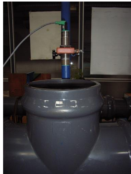
Obrázek 33 - Měření úrovně hladiny s ultrazvukovou sondou [62]
