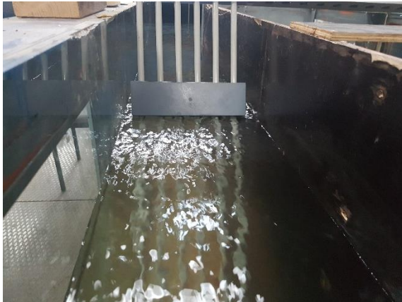
Obrázek 50 - Pohyblivé příložky garantující volnou délku a natočení prutů česlí
