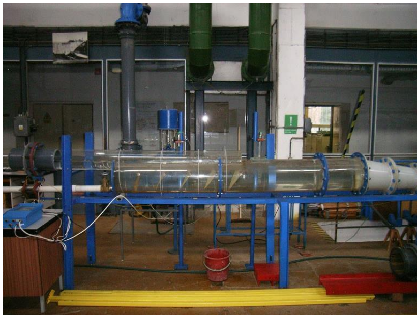
Obrázek 30 - Fyzikální model Hobas CSO Chamber [62]
