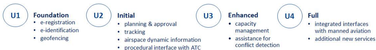
Obrázek 1: Časová osa zavádění jednotlivých prvků konceptu U-space [18]
