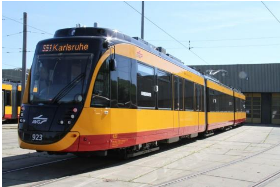
Obrázek 9 - Bimodální tramvaj používaná v německém Karlsruhe
