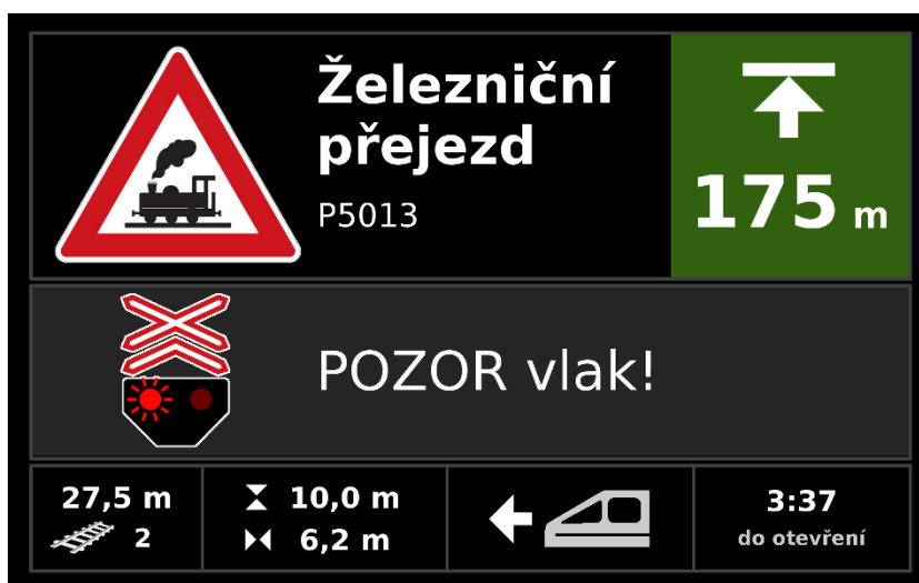
Obrázek 15: Informace na HMI při uzavřeném přejezdu
