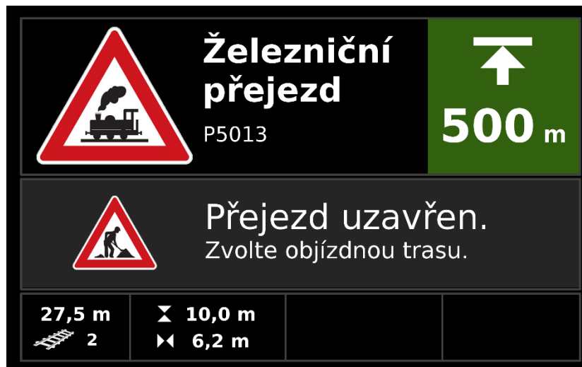
Obrázek 16: Informace na HMI při rekonstrukci přejezdu
