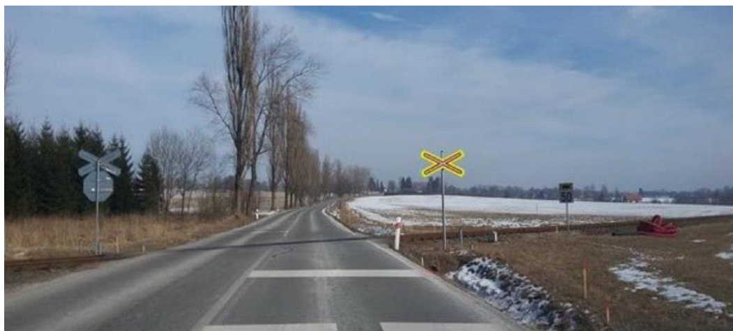
Obrázek 11: Přejezd zabezpečený výstražným křížem [35]
