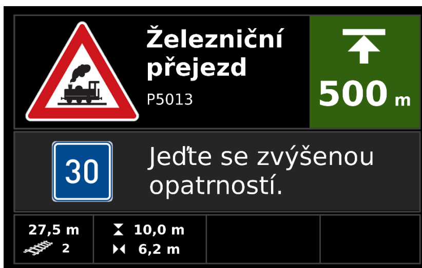
Obrázek 14: Informace na HMI při otevřeném přejezdu
