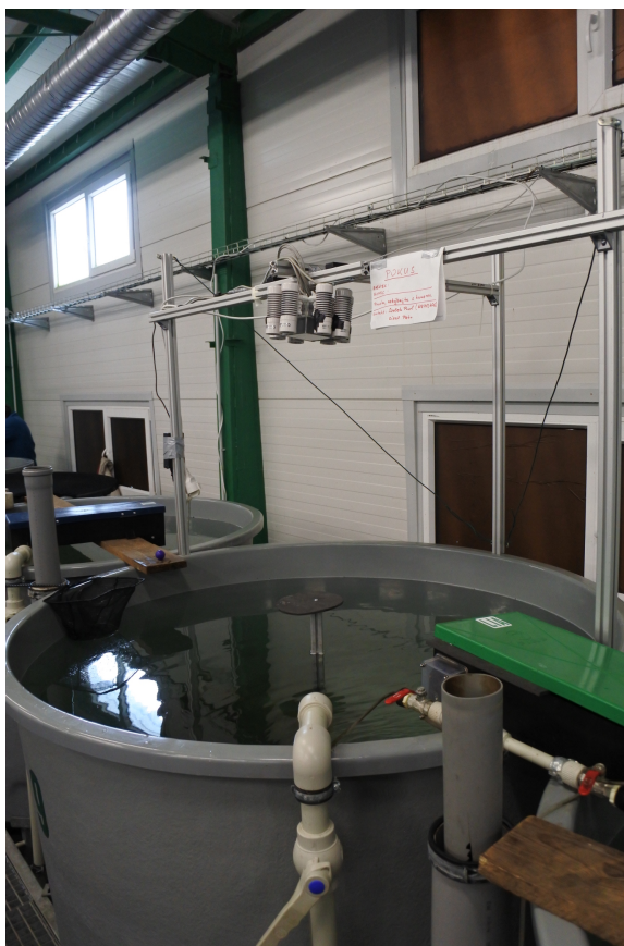
Obrázek 1.4: Stanovení rychlosti proudění pomocí stereovize
