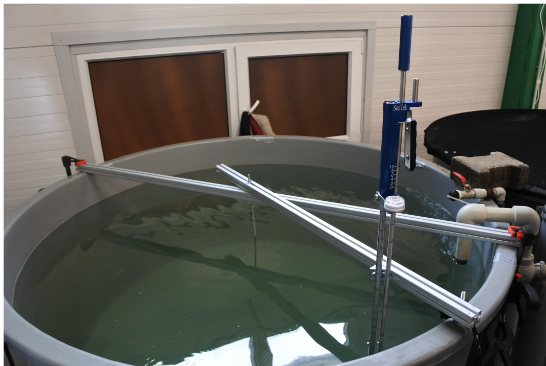
Obrázek 3.4: Umístění vodících tyčí na nádobě
