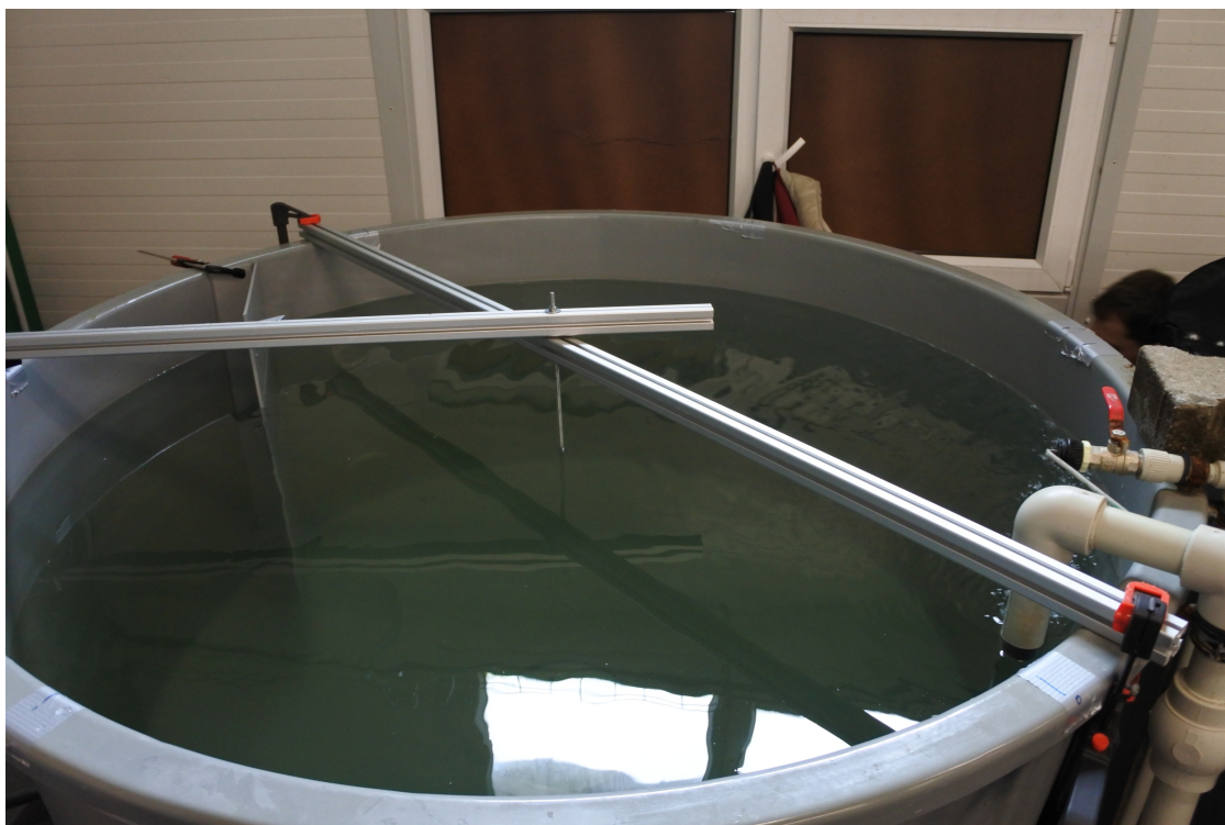
Obrázek 7.1: Instalace přepážky v nádobě
