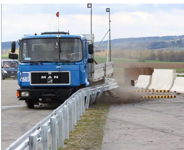
Obr. 23 Výjezd vozidla po nárazu do záchytného systémem v porovnání s 3D modelem
