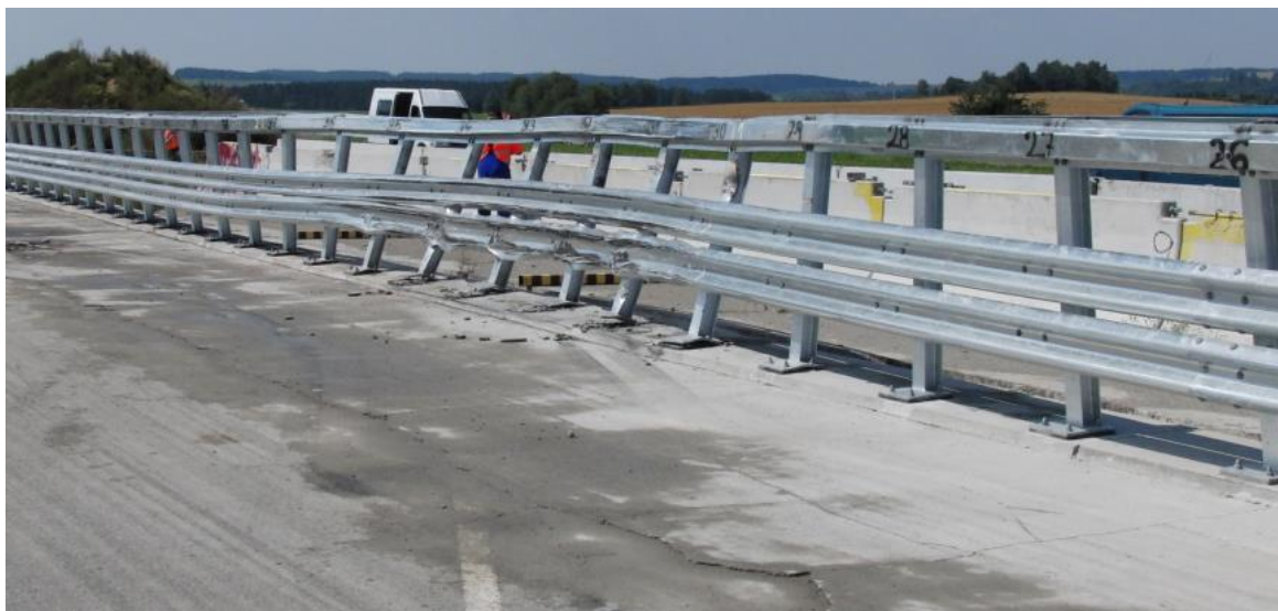
Obr. L6 Ilustrační fotografie deformace záchytného systému po zkoušce
