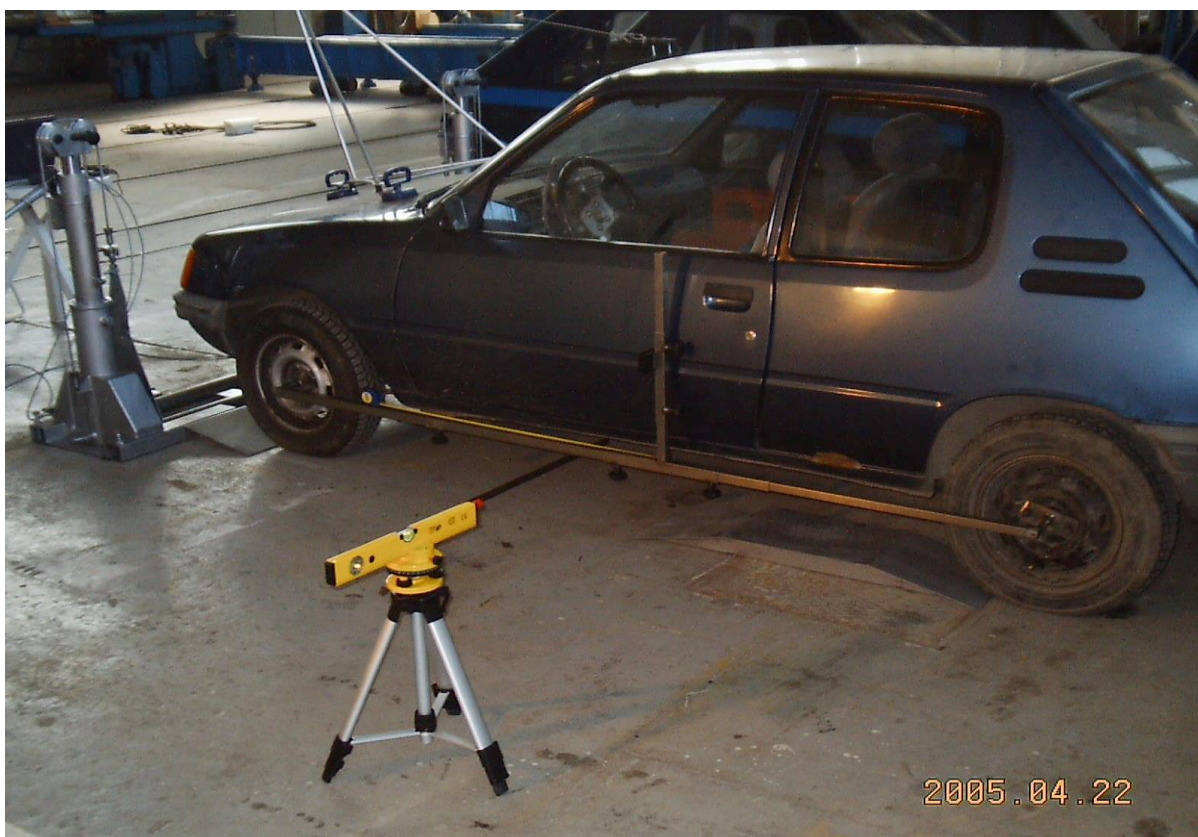
Obr. 4 Vytyčení těžiště ve vozidle laserovým systémem
