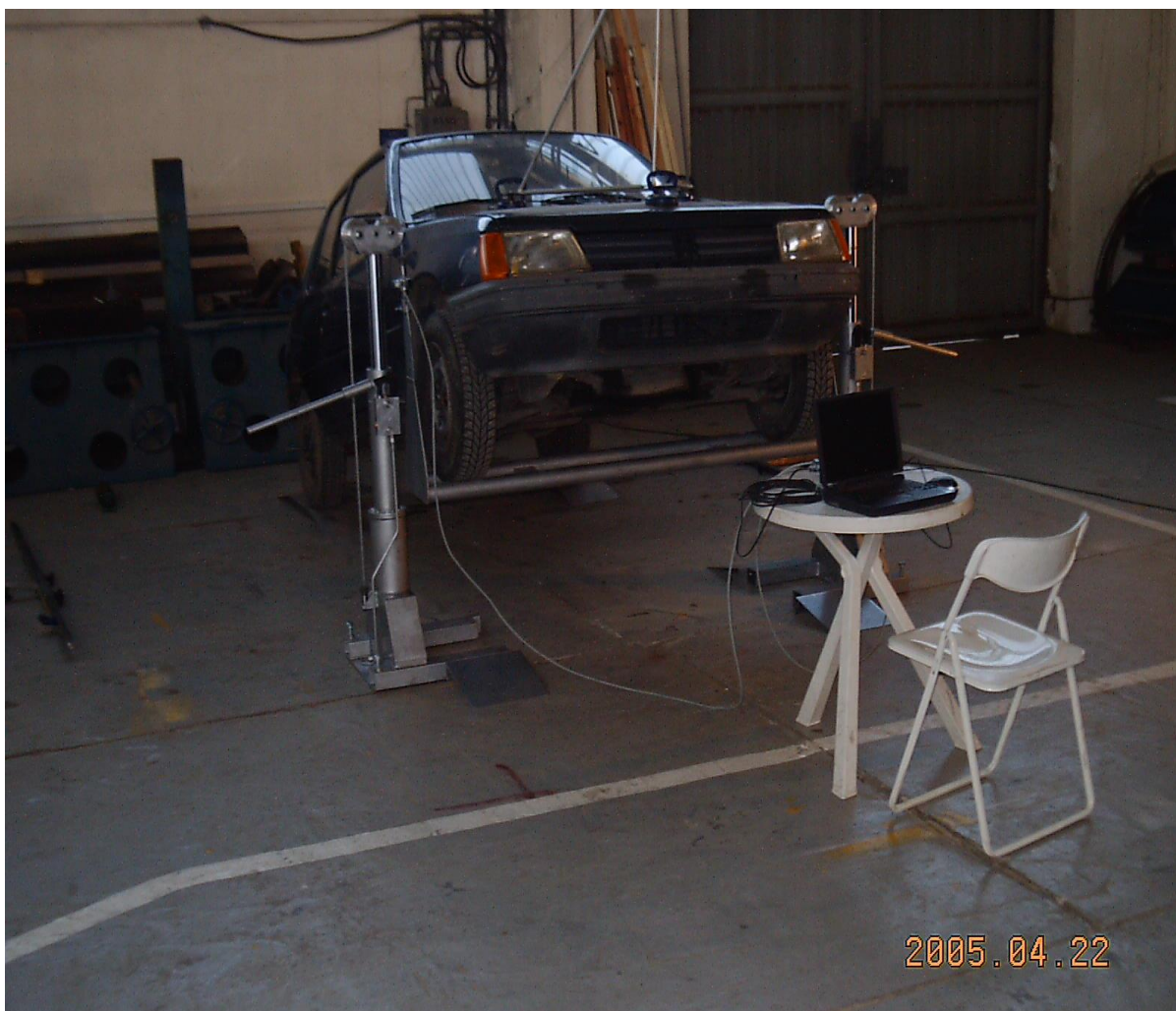
Obr. 2 Zařízení pro měření těžiště vozidla ZVST – 01, 10 kN
