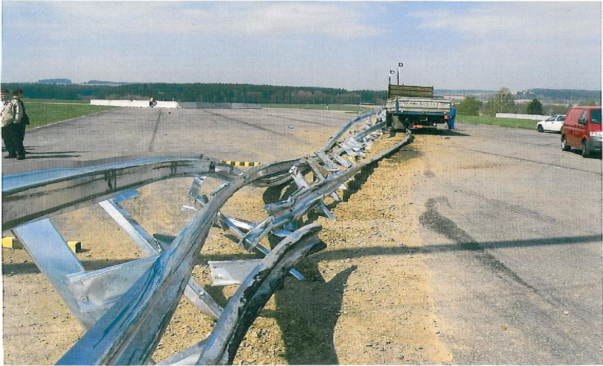
Obr.11 Vzorek ocelového svodidla po zkoušce
