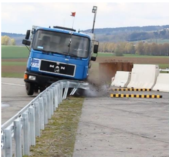
Obr. 22 Maximální dynamický průhyb záchytného systémem v porovnání s 3D modelem
