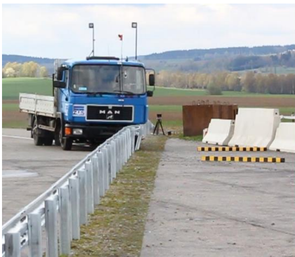
Obr. 21 První kontakt vozidla se záchytným systémem v porovnání s 3D modelem
