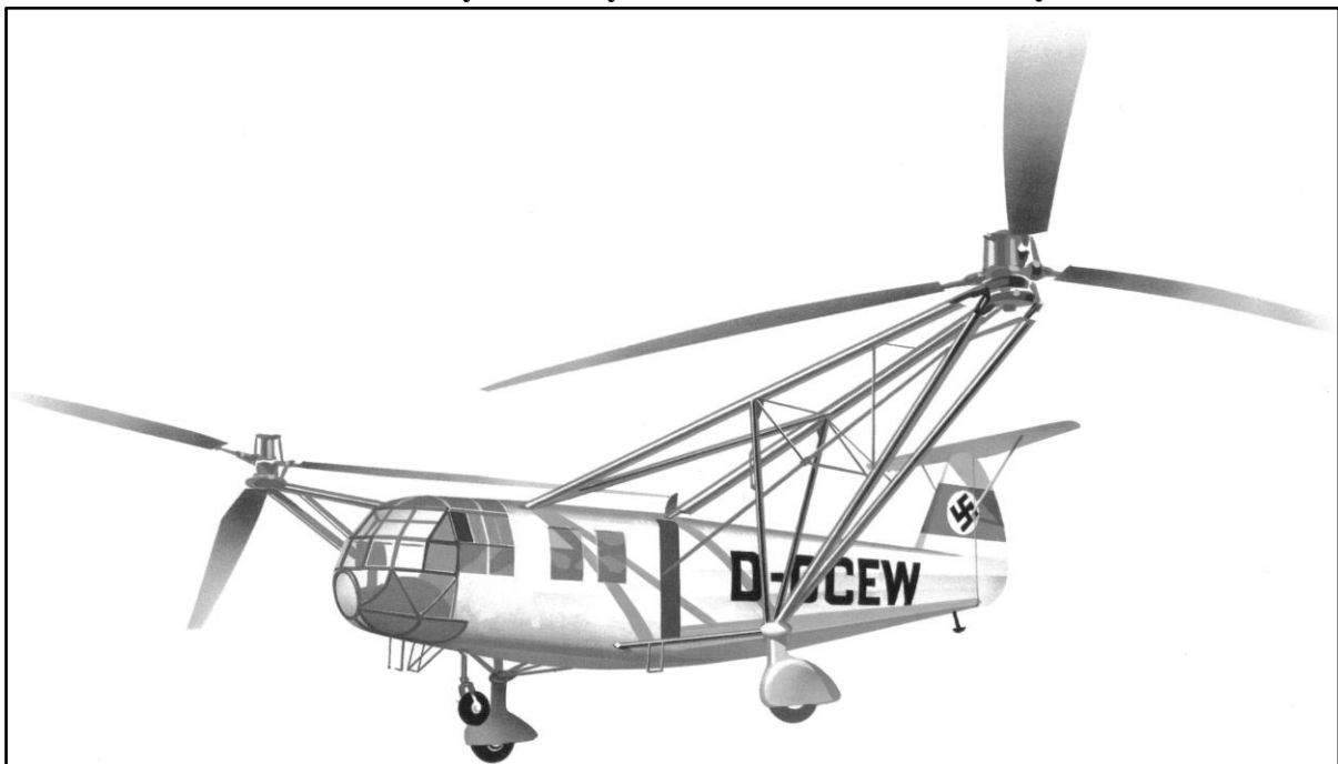
Obr. 3. Focke-Achgelis Fa 223, příklad dvourotorového vrtulníku s rotory uloženými příčně.
