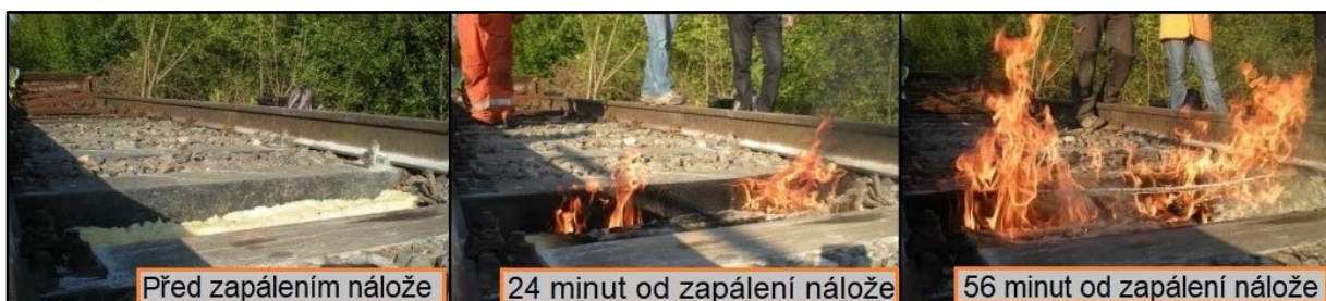
Obr. 73: Časosběrné snímky z požární zkoušky (hoření iniciační nálože požáru a přilehlého pražce - k rozvoji požáru na další pražce po dobu 64 minut nedošlo) [9]
