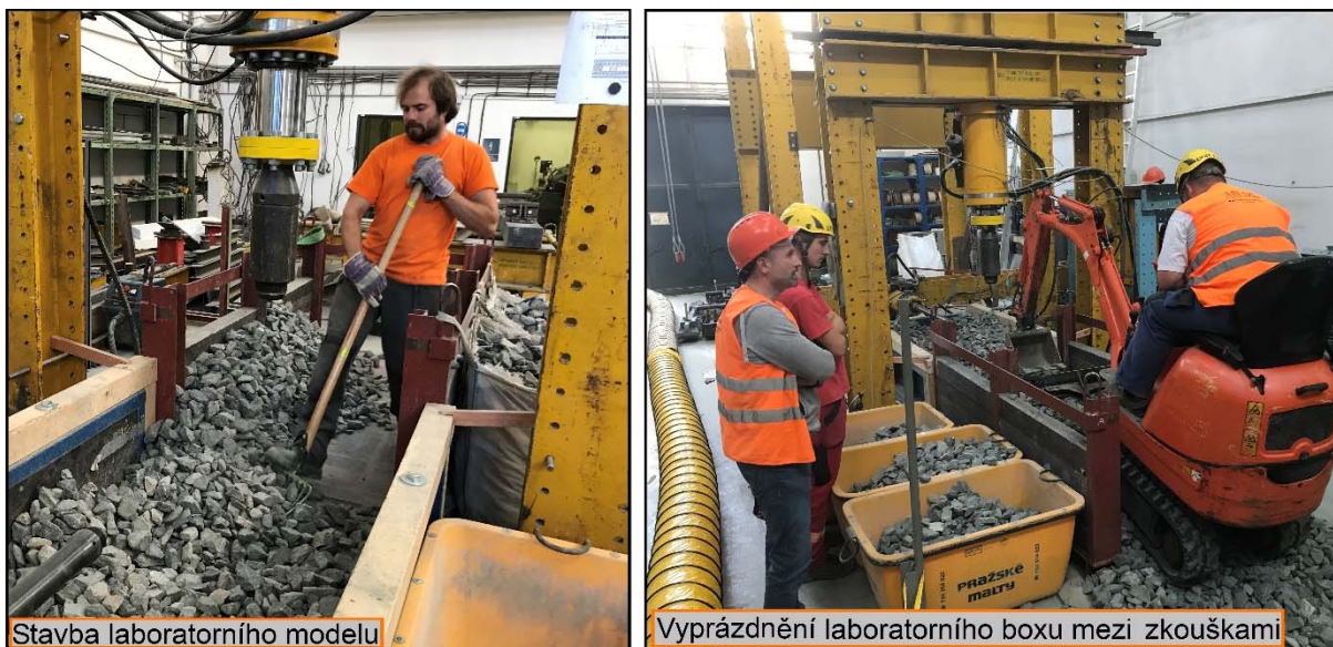
Obr. 52: Stavba laboratorního modelu pro stanovení příčného odporu pražce
