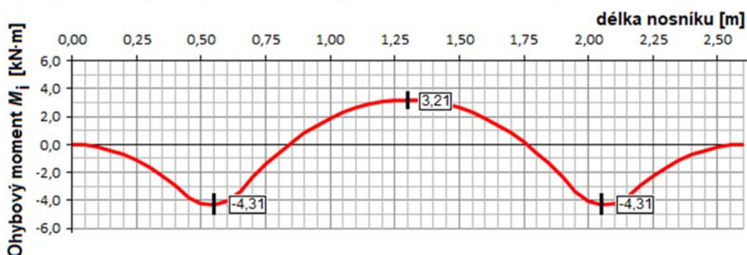
C) Ohybový moment M_i pražce pod zatížením s vyznačením hodnot v důležitých bodech
