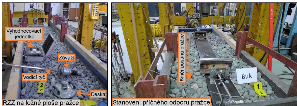
Obr. 55: Laboratorní model ve fázi provádění RZZ a ve fázi před stanovením příčného odporu pražce
