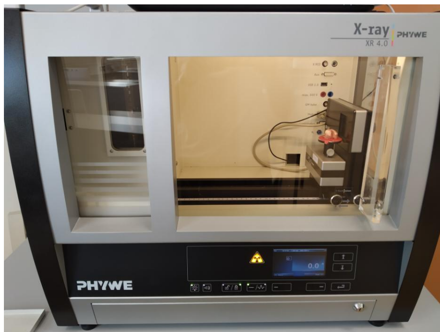
Obr. 4.3: Sestava Phywe 4.0 připravená k použití [zdroj: autor]
