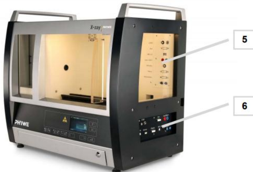
Obr. 4.2: Sestava Phywe XR 4.0: 5 – vnitřní propojovací panel v experimentálním prostoru, 6 – vnější propojovací panel. [46]
