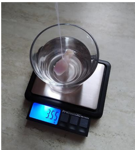
Obr. 4.14: Měření objemu vzorku masa na váze [zdroj: autor]
