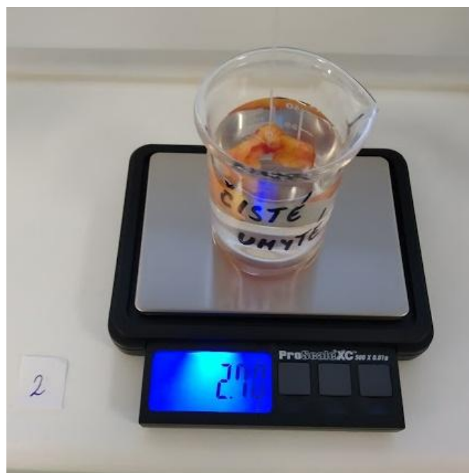
Obr. 4.26: Fotografie z měření objemu na váze [zdroj: autor]
