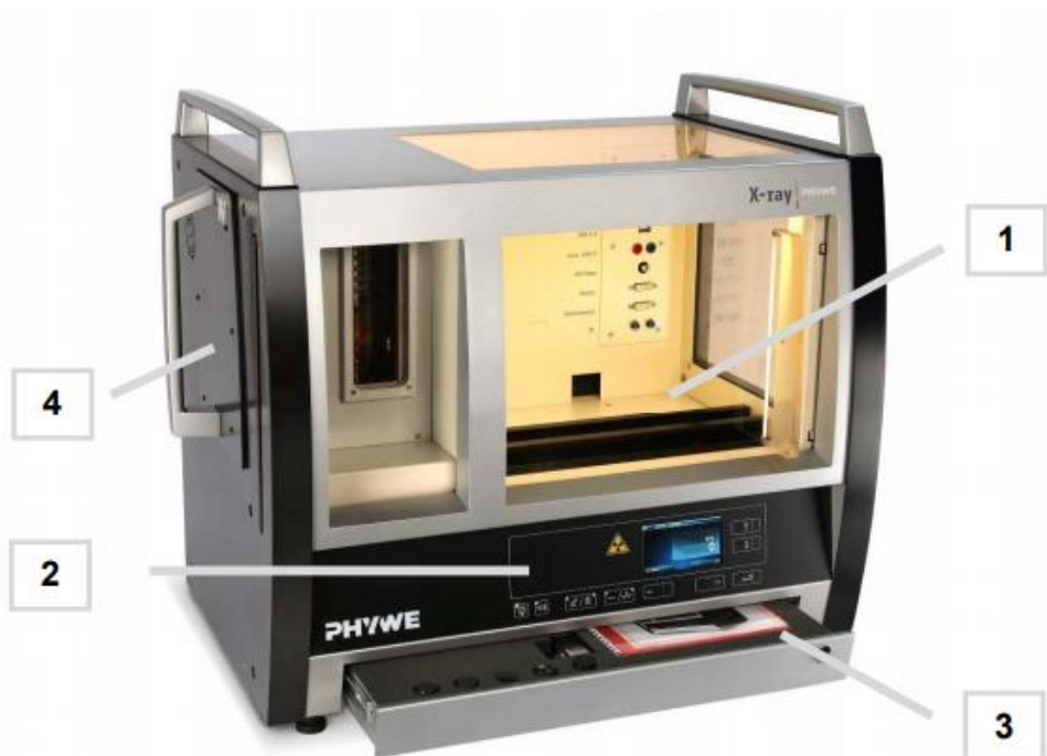
Obr. 4.1: Sestava Phywe XR 4.0: 1 – experimentální prostor, 2 – ovládací panel, 3 – zásuvka na příslušenství, 4 – zásuvný blok s rentgenkou. [46]
