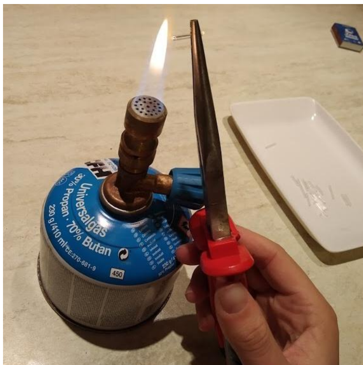
Obr. 4.9: Zatavování kapilár nad kahanem [zdroj: autor]
