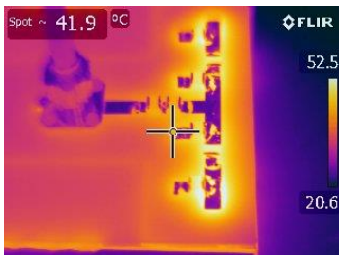
Obr. 7.4: Zahřívání mikropáskového vedení a substrátu. Foceno z IR kamery po 15 minutách zahřívání
