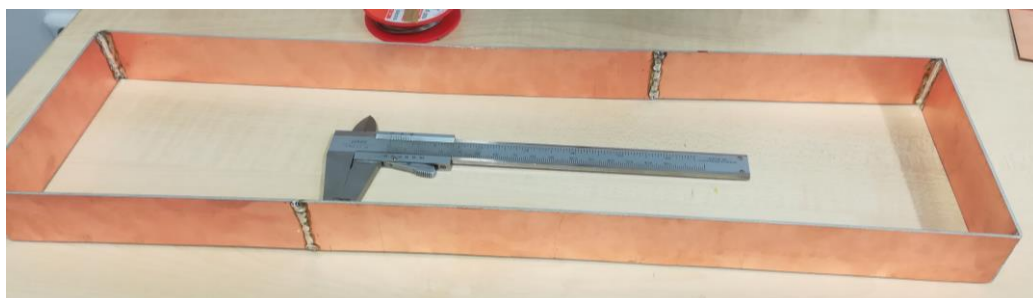
Obr. 10.2: Sestavené stínění okolo aplikátoru. Stínění je vytvořeno ze substrátů, aby zachovalo lépe tvar
