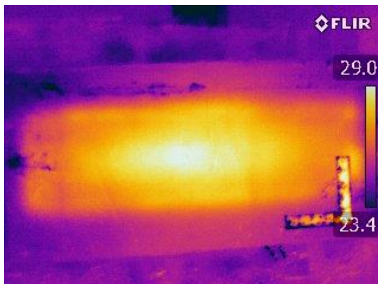
Obr. 7.3: Rozložení teplotního pole v řezu v hloubce 10 mm v tkáni. Rozložení teplot odpovídá i rozložení SAR. Jako měřítko slouží přiložené pravítko o vnějších hranách 100 mm
