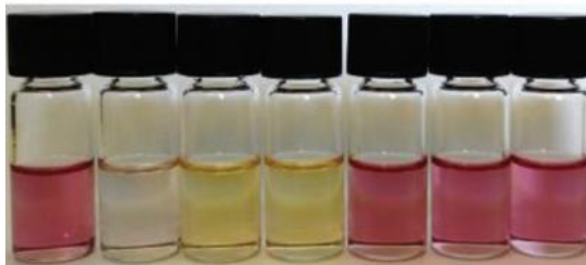
Obrázek 10 – chromogenní reakce testovacího roztoku (1) (zleva) s tabunem, sarinem, VX, acetyl chloridem, sírným yperitem, kyslíkatým yperitem [25]
