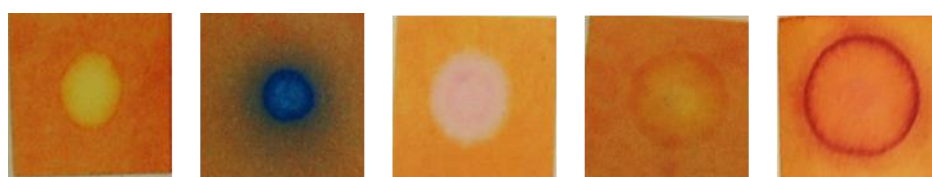
Obrázek 25 – barevné změny na papírku s kombinací činidel RM1a a bromkresolové zeleně po reakci zleva s DCMP, DETA, DCP, CEES, difosgenem
