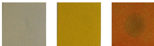
Obrázek 43 – rušivý vliv vody na papírky impregnované zleva RM1a; RM1a a PY-ODP; kombinací RM1a, PY-ODP, bromkresolovou zelení a Ellmanovým činidlem
