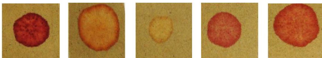
Obrázek 50 - barevná odezva na vybrané rušivé vlivy na PP-3; zleva trichlormethan, aceton, ether, sirouhlik, ethanthiol,
