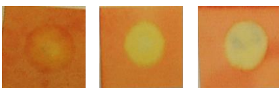
Obrázek 26 – rozdíly v intenzitě barevné změny při detekci CEES na papírku impregnovaném zleva činidly RM1a a bromkresolovou zelení; kalafunou a činidly; kalafunou, činidly a kamencem
