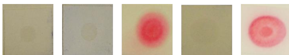
Obrázek 23 – detekce (zleva) DCMP, DETA, DCP, CEES, difosgeny papírkem impregnovaným RM1a
