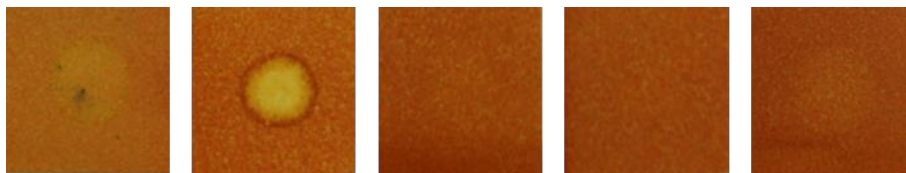
Obrázek 42 - papírky impregnované RM1a, PY-ODP, bromkresolovou zelení a Ellmanovým činidlem po kontaktu zleva s trichlormethanem, acetonem, etherem, sirouhlikiem a ethanthiolem
