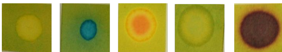
Obrázek 27 – barevné změny na papírku s kombinací činidel RM1a, PY-ODP a bromkresolové zeleně po reakci zleva s DCMP, DETA, DCP, CEES, difosgenem
