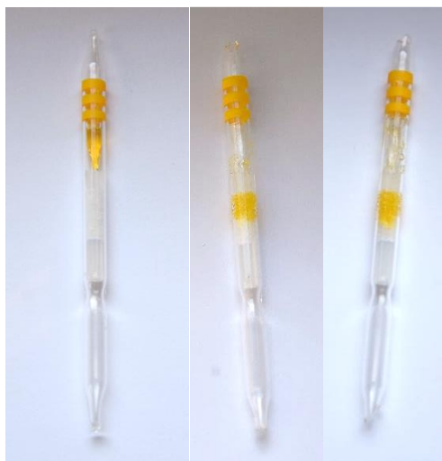
Obrázek 11 DT-16: vlevo nepoužitá trubička, uprostřed negativní trubička vystavená nasyceným parám sirouhlíku, vpravo tzv. slepá (byl skrze ni prosát čistý vzduch) (zdroj: autor)
