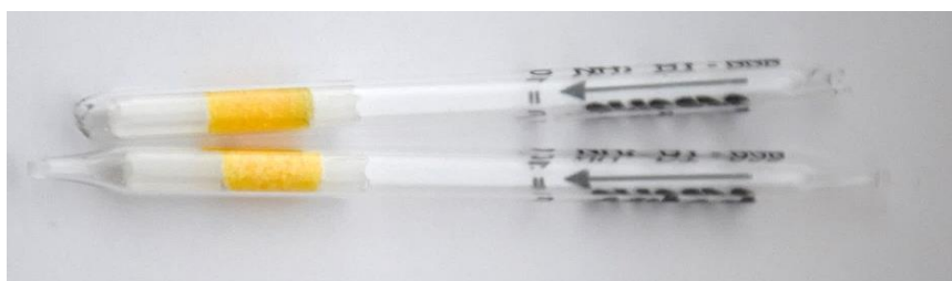
Obrázek 18 DT-008: porovnání neotevřené trubičky (na fotografii dole) a trubičky vystavené koncentraci 100 mg/m 3 (zdroj: autor)
