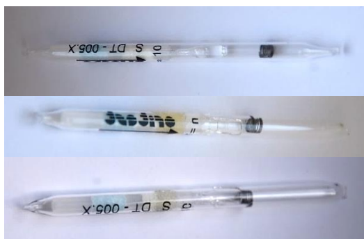
Obrázek 14 DT-005X: Nahoře nepoužitá trubička, uprostřed tzv. slepá trubička (byl skrze ni prosát jen čistý vzduch), dole negativní trubička vystavená 1l vzduchu s koncentrací sirouhlíku 100 mg/m 3 (zdroj: autor)
