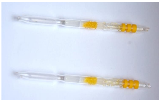
Obrázek 7 DT-16: nahoře negativní trubička na hydrazin, dole tzv. slepá trubička (zdroj: autor)
