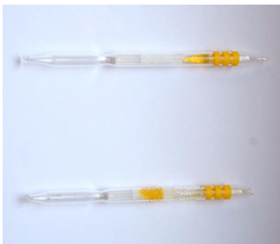
Obrázek 6 DT-16: nahoře nepoužitá trubička, dole negativní trubička vystavení hydrazinu vpravo (zdroj: autor)
