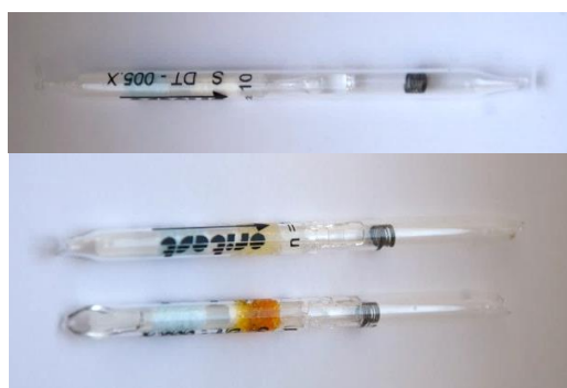
Obrázek 9 DT-005X: nahoře nepoužitá trubička, uprostřed použitá tzv. slepá (nevystavená testované látce) a dole pozitivní trubička vystavená sirouhlíku (zdroj: autor)
