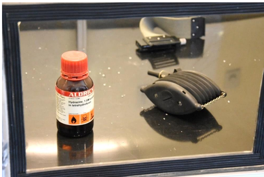
Obrázek 2 Vpravo nasávací zařízení Universal 86, vlevo balení roztoku 1M hydrazinu v tetrahydrofuranu, vzadu zařízení sloužící k přípravě trubiček (na odlamování konců trubiček a rozbíjení ampulek s činidly) (zdroj: autor)
