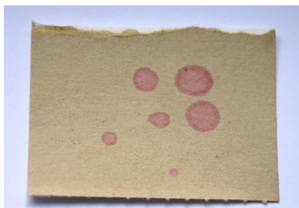
Obrázek 20 PP-3: reakce detekčního papírku na sirouhlík (zdroj: autor)
