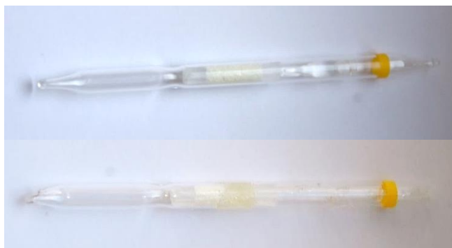
Obrázek 10 DT-13.1 nahoře nepoužitá trubička, dole negativní trubička vystavená sirouhlíku (zdroj: autor)
