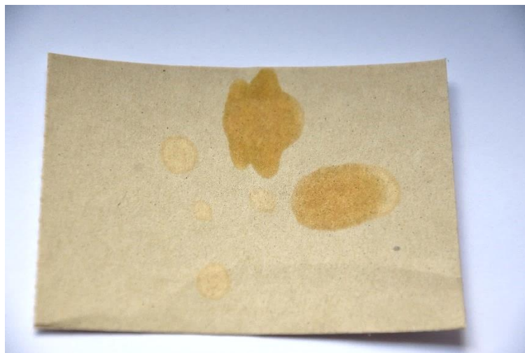
Obrázek 21 PP-3: detekční papírek reagující na ethanol (96%) (zdroj: autor)
