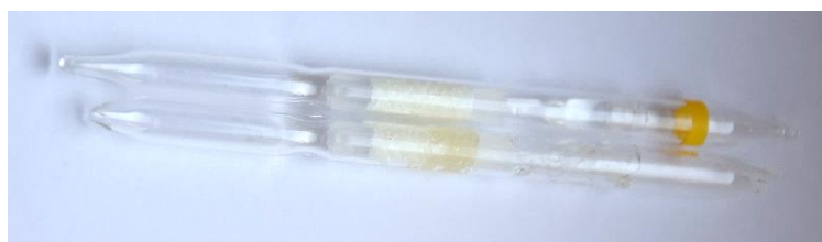
Obrázek 5 DT-13.1: nahoře nepoužitá trubička, dole negativní výsledek na hydrazin (zdroj: autor)
