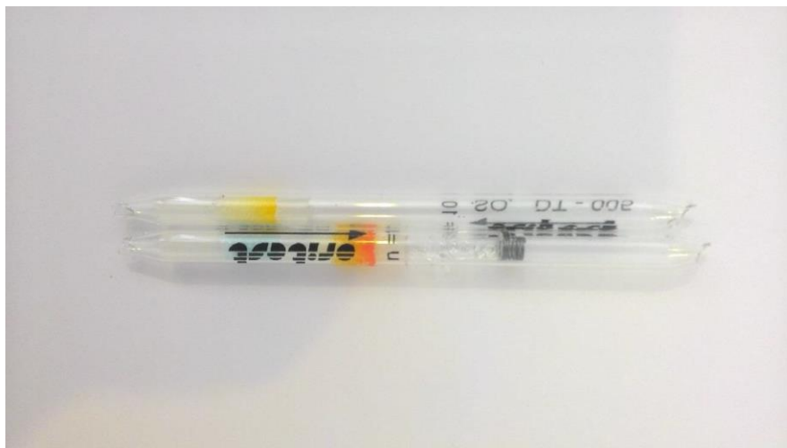
Obrázek 23 Snímek detekční trubičky DT-005 (horní) a detekční trubičky DT-005-X, obě exponované 2-butylaminoethanethiolu (koncentrace 100 mg.m -3 , 10 zdvihů) (48)
