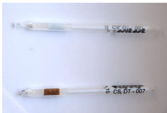
Obrázek 8 DT-007: nahoře nepoužitá trubička, dole pozitivní trubička exponovaná nasyceným parám sirouhlíku (zdroj: autor)
