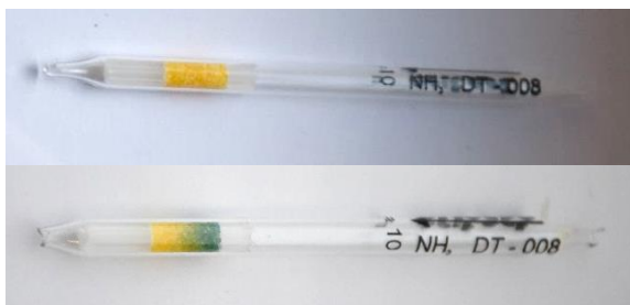
Obrázek 16 DT-008: nahoře nepoužitá trubička, dole pozitivní trubička na nasycené páry 2-(butylamino)ethanthiolu (zdroj: autor)
