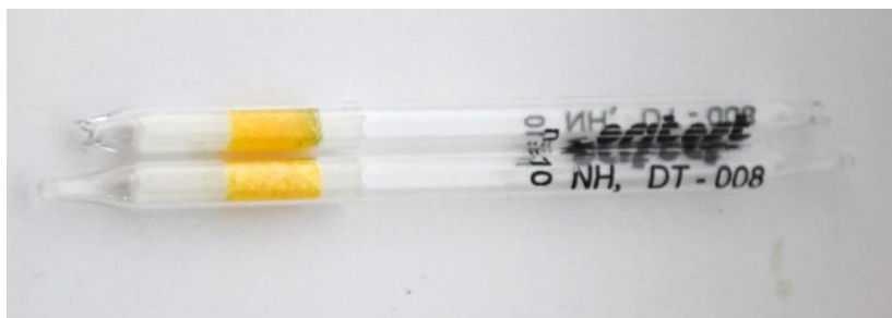
Obrázek 17 DT-008: porovnání neotevřené detekční trubičky (na fotografii dole) s trubičkou vystavené koncentraci 200 mg/m 3 (zdroj: autor)
