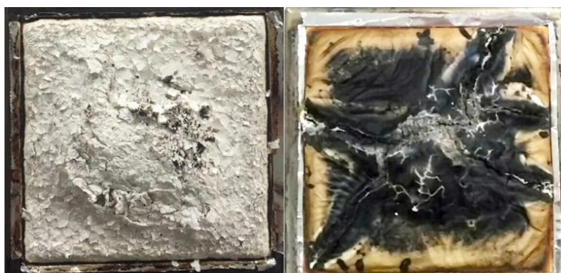
Obrázok 12 PE + hydroxid horečnatý Mg(OH)_2 pred a po teste
