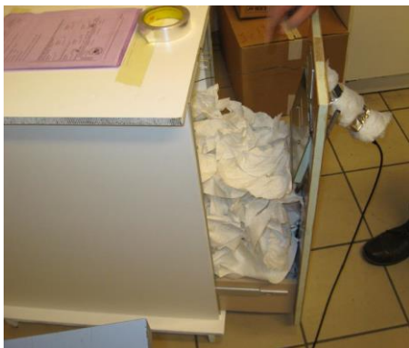
Obrázok 22 Príklad aranžovania požiarneho testu lietadlového odpadkového koša
