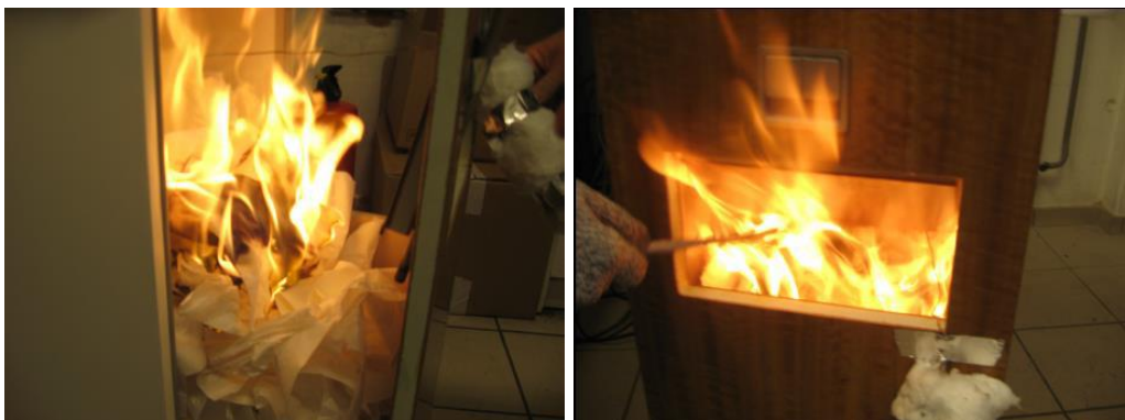
Obrázok 22 Príklad aranžovania požiarneho testu lietadlového odpadkového koša
