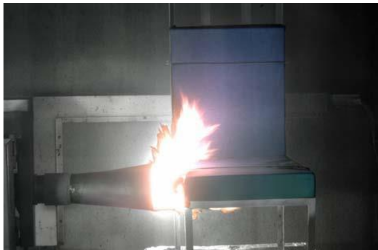
Obrázok 24 Test horľavosti sedadiel olejovým horákom
