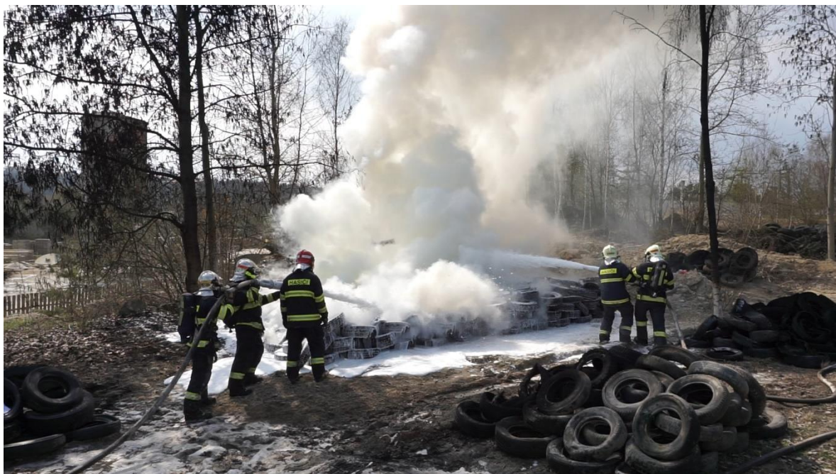
Obrázek 43 - Praktický experiment pokus č.8 likvidace plamenného hoření [zdroj autor]
