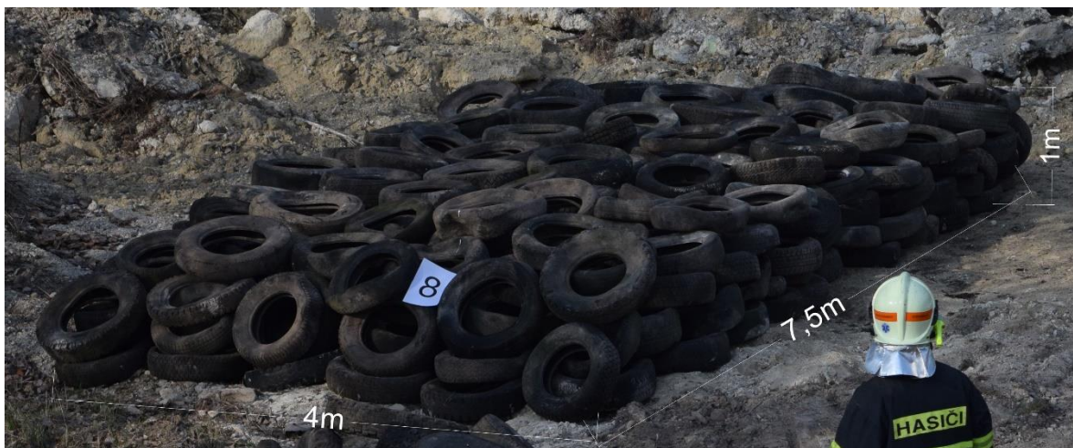
Obrázek 8 - Rozměry hranice pneumatik pro pokus č.8 [zdroj autor]
