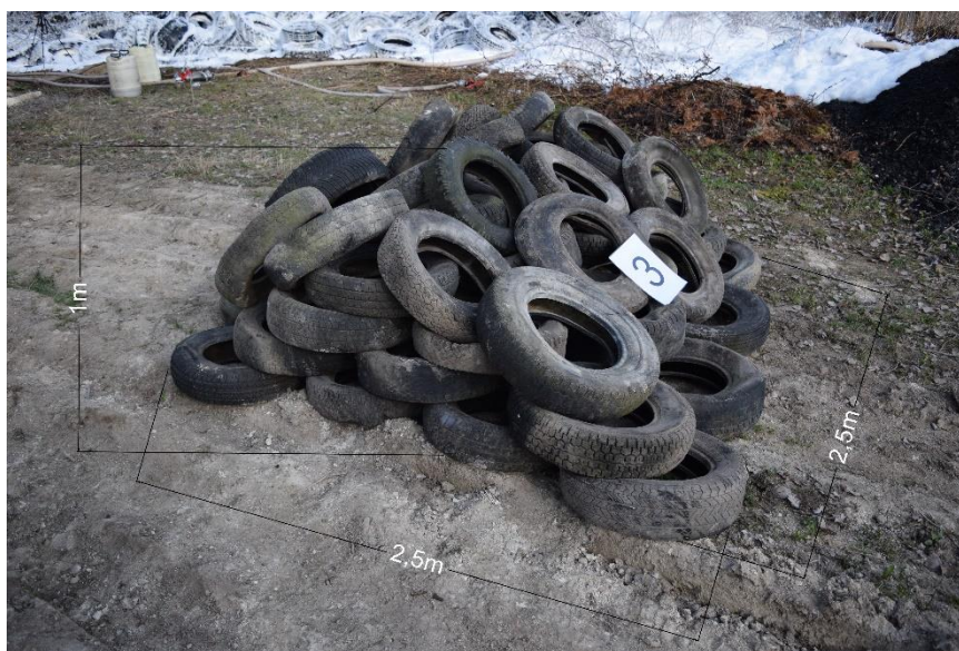
Obrázek 7 - Rozměry hranice pneumatik pro pokus 1-7 [zdroj autor]
