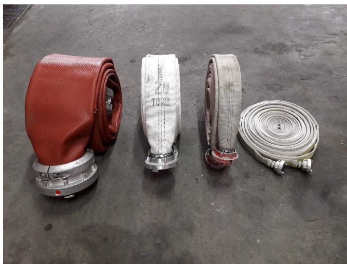
Obrázek 13 - Hadice v kotouči (A, B, C, D) [zdroj autor]
