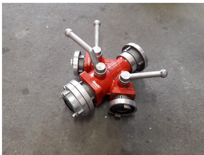
Obrázek 15 - Hadicový rozdělovač [zdroj autor]
