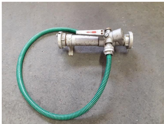
Obrázek 18 - Přenosný přiměšovač s regulací a savičkou D [zdroj autor]
