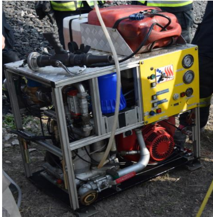
Obrázek 22 - Zařízení CAFS - One seven [zdroj autor]
