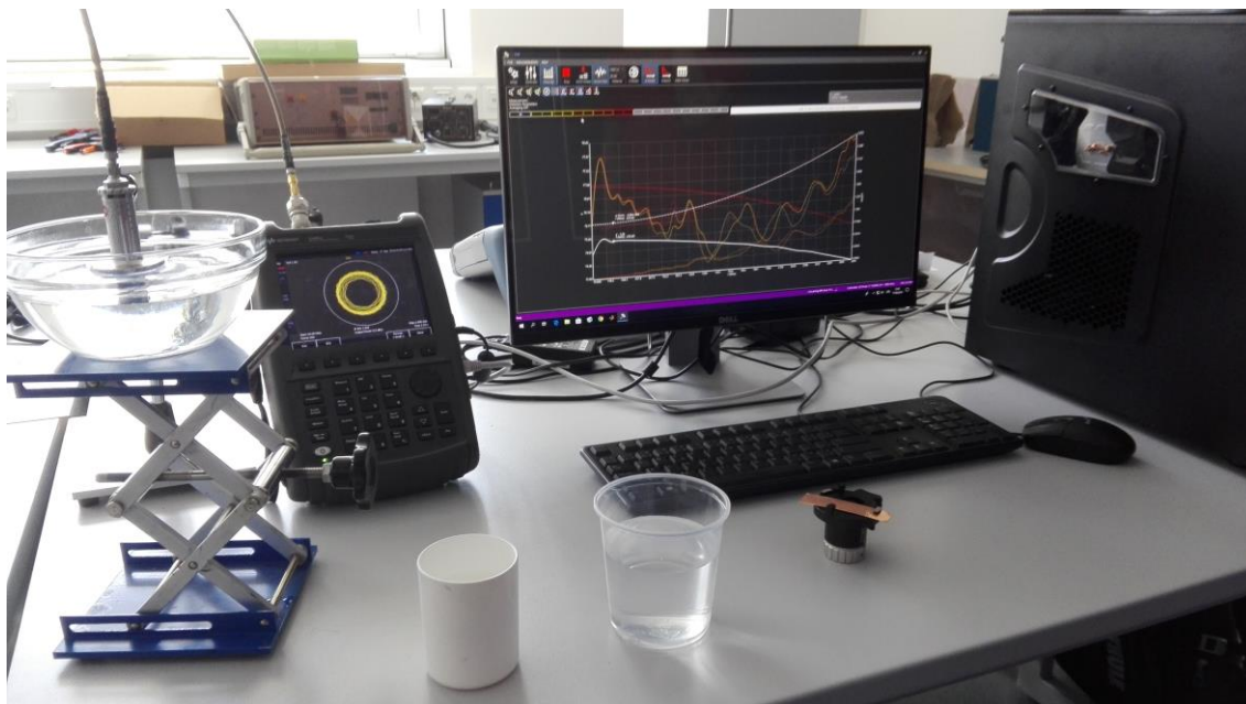
Obr. 3.28.: Zobrazení měřící sestavy komerční sondy. Sonda měří permitivitu a konduktivitu vytvořeného tekutého fantomu prsu. Signál ze sondy vstupuje do vektorového analyzátoru, který odesílá data dále do PC jednotky, kde jsou zpracovávány softwarem komunikujícím s měřící sondou. Na stole lze také vidět pomůcky využívané pro kalibraci sondy (viz. metody).
