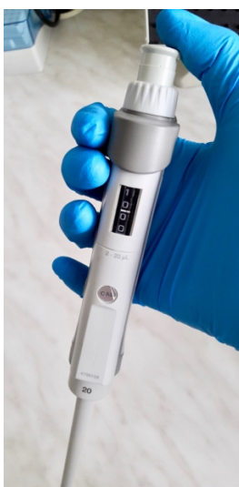
Obrázek 7 Automatická pipeta firmy Eppendorf s nastaveným objemem 10 \mu l. Při práci v laboratoři je nevyhnutelné celou dobu dbát na používání ochranných pomůcek, hlavně rukavic a ochranného oděvu. Fotografii jsem pořídila během pracovního postupu zpracování vzorků praktické části bakalářské práce.
