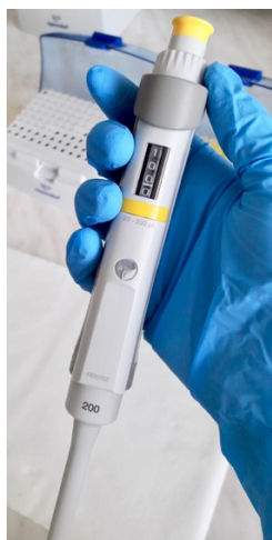
Obrázek 9 Automatická pipeta firmy Eppendorf s nastaveným objemem 100 \mu l. Pipetou jsem přidala nastavený objem krve do zkumavky k fluorescenčnímu barvivu. Takto připravené vzorky se musí protřepat. Fotografii jsem pořídila během pracovního postupu zpracovávání vzorků praktické části bakalářské práce.
