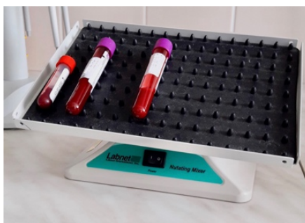
Obrázek 6 Hematologická třepačka firmy Sigma-Aldrich, USA. Vzorky se míchají od okamžiku příjmu vzorku laboratoří až do samotného začátku zpracování a přípravy vzorku na měření. Fotografii jsem pořídila během pracovního postupu zpracování vzorků praktické části bakalářské práce.
