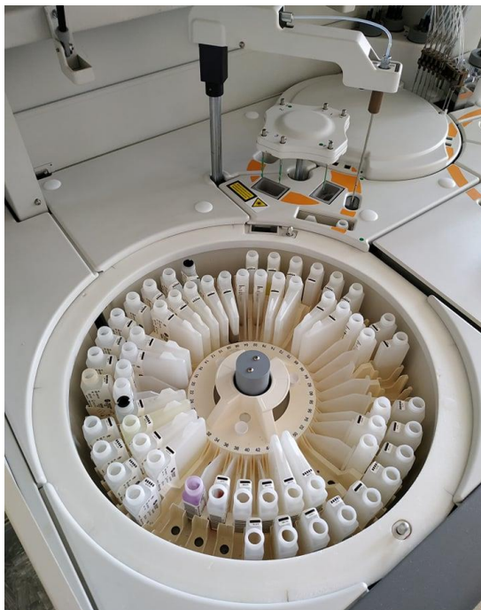
Obrázek 12 – Zásobník reagentií v chladicím prostoru analyzátoru [vlastní zdroj].
