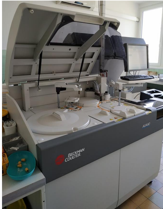
Obrázek 10 - Analyzátor Beckman Coulter AU480 otevřený [vlastní zdroj].
