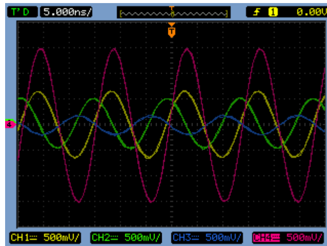
Obrázek 4.8: Ukázka výstupů generátoru zobrazených osciloskopem (pro různě nastavené fáze a amplitudy, frekvence je 70 MHz)
