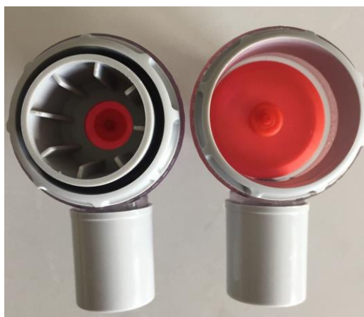
Obrázek 5: Jednocestný ventil před (vlevo) a po úpravě (vpravo).
