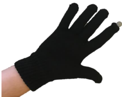
Obrázek 2.5 Fotografie rukavice se značkou umístěnou na ukazováku ruky
