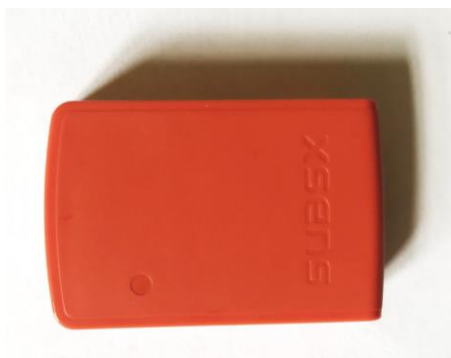
Obrázek 2.2 Fotografie akcelerometru ze sady MT Awinda (foto autor)
