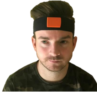
Obrázek 2.7 Fotografie umístění akcelerometru na čelence na čele figuranta
