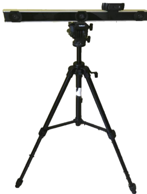
Obrázek 2.1 Fotografie kamerového systému Optitrack včetně připevněné kamery (popis kamery v kapitole 2.2.3) (foto autor)
