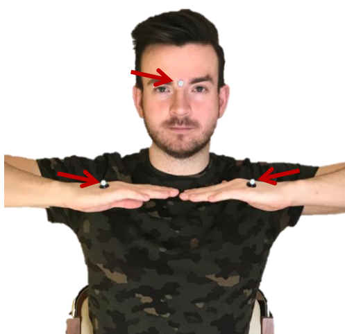
Obrázek 2.4 Fotografie umístění značek na rukách a čele na figurantovi (optické značky jsou zvýrazněny červenou šipkou)
