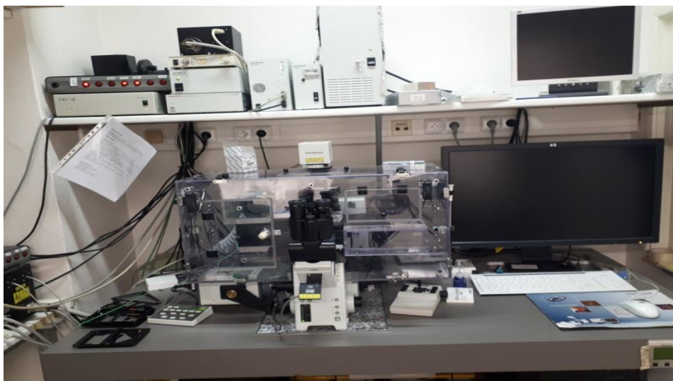
Obr. 2.10: Konfokální laserový biologický mikroskop Olympus FluoView FV1000 Zdroj: vlastní foto
