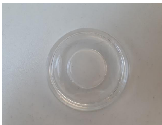
Obr. 2.1: Miska se skleněným dnem, která umožňuje vizualizaci buněk pod konfokálním mikroskopem (průměr misky 3,5 cm; průměr skla 1,3 cm)
