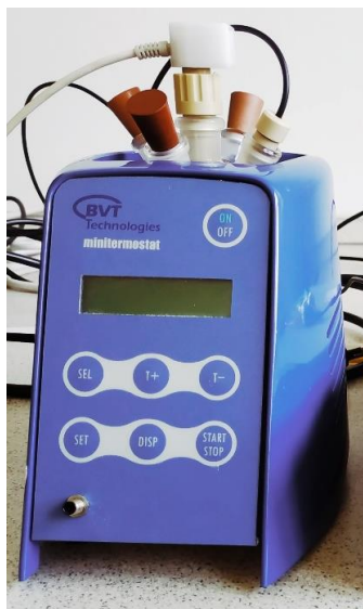
Obrázek A.1: Termostat MT-1 s elektrochemickou celou, míchadlem a elektrodou.
