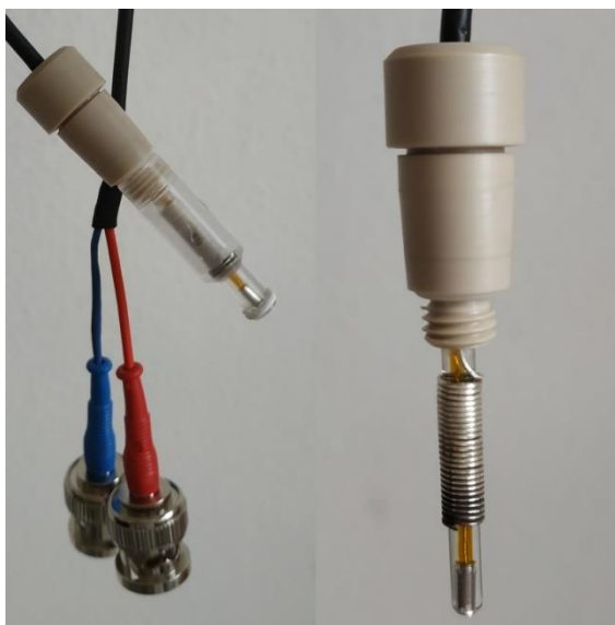
Obrázek 3.5: Miniaturní kyslíková elektroda s membránou a BNC konektory (vlevo); miniaturní kyslíková elektroda bez krytu a membrány (vpravo)
