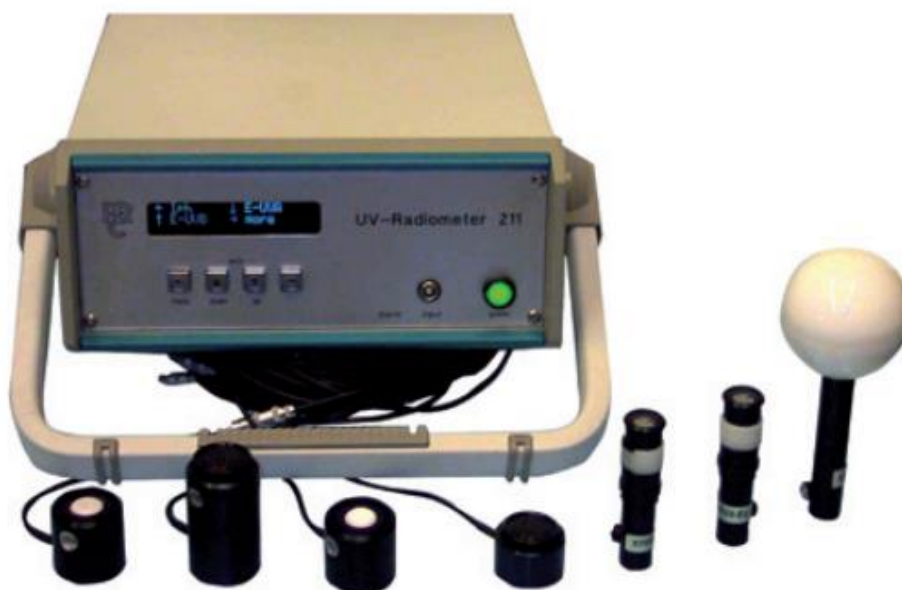
Obrázek 18: Přesný digitální luxmetr a radiometr typu 211 PRC Krochmann [39]
