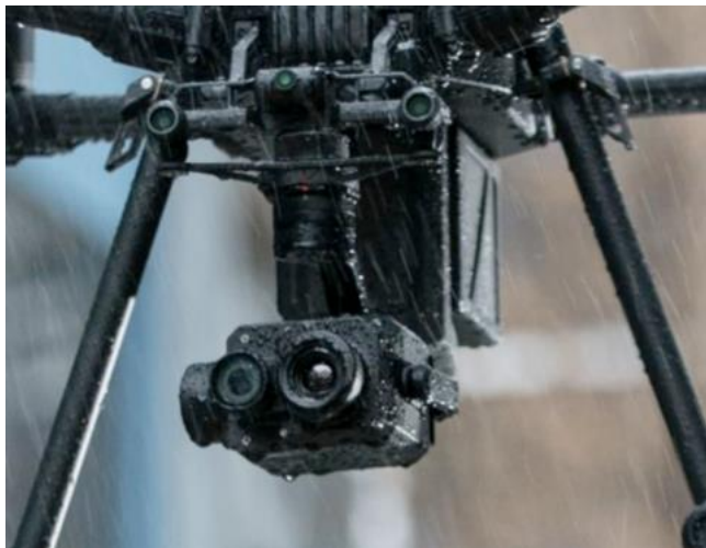
Obrázek 7 Termo-kamera Zenmuse XT2 na dronu Matrice[46]
