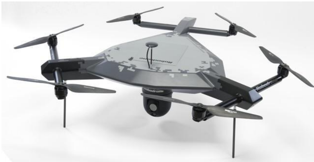
Obrázek 2 Hexakoptéra Robodrone Kingfisher využívaný HZS ČR [6]
