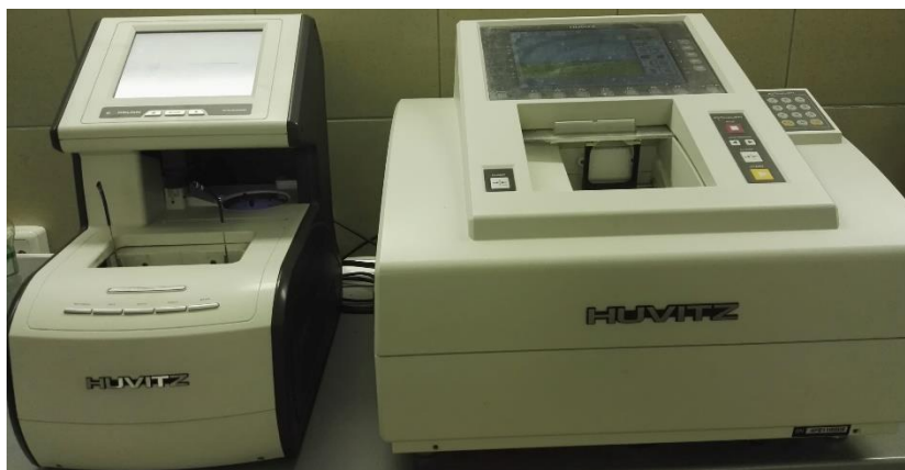
Obrázek 17 Automatický brus Excelon s centrovací věží
