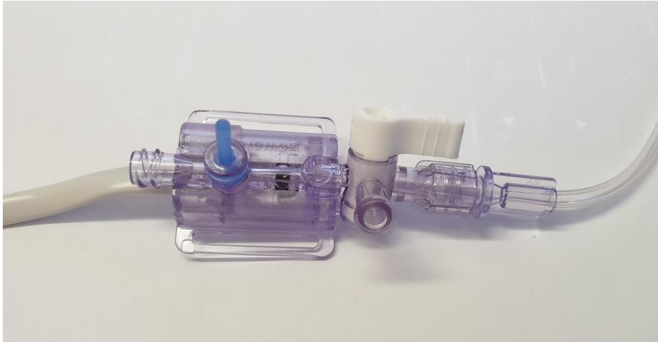
Obrázek 1.6 Měřící komůrka se senzorem extravaskulárního katetru plněného tekutinou
