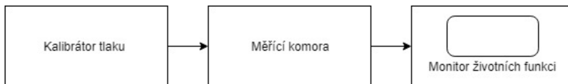
Obrázek 2.4 Schéma zapojení kalibrátoru tlaku pro analyzování měřicí komory
