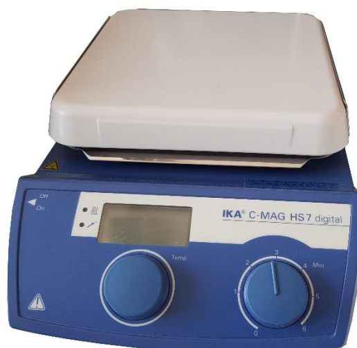
Obrázek 19: Magnetická míchačka IKA C-MAG HS7
