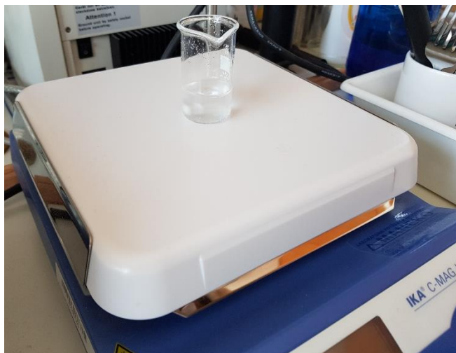
Obrázek 26: Magnetická míchačka a kádinka s polymerizační směsí
