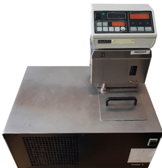
Obrázek 21: Termostat s vodní lázní HAAKE F4
