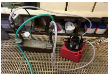
Obr. 6 Zapojení tepelného výměníku do čisticího okruhu [8A].
