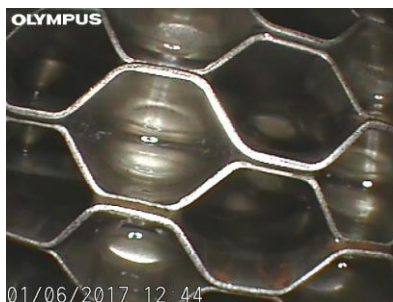
Obr. 10 Defektoskopický snímek zaneseného výměníku před chemickým čištěním (vlevo) a výměníku po chemickém čištění (vpravo) [8A, 9A].
