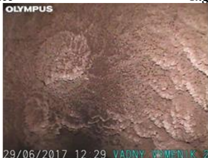
Obr. 7 Endoskopický snímek nejzanesenějšího místa vstupu primární strany výměníku [7A].
