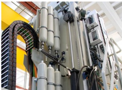
obr. 13 Jobs JOMAX 269 se dvěma hydromotory napojenými na kaskádu akumulátorů a kladkami, které jsou upevněny na valivých vedení [11]
