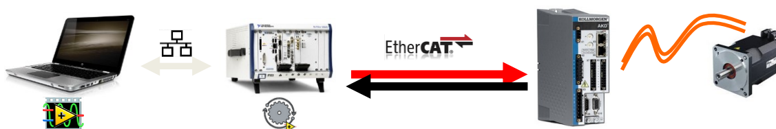
obr. 68 Řízení servomotoru RealTime kontrolérem NI PXI za pomoci LabView modulu SoftMotion
