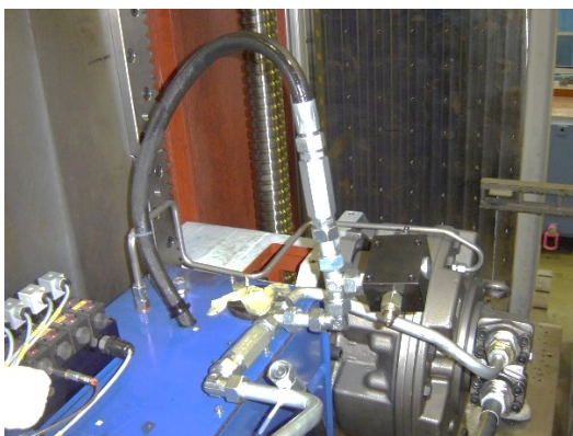
obr. 27 Detail vřeteníku s vyvažovacím hydromotorem, ozubeným hřebenem a kuličkovým šroubem v pozadí [37]
