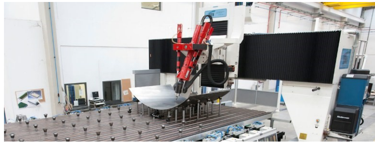
obr. 4 Obráběcí stroj Loxin PKM Tricept [9]
