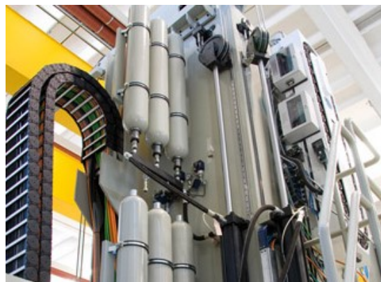
obr. 21 Jobs JOMAX 269 se dvěma hydromotory napojenými na kaskádu akumulátorů a kladkami, které jsou upevněny na valivých vedení [23]
