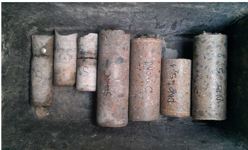
Obrázek 20 Vývrty odebrané při průzkumu konstrukce pro laboratorní zkoušky (část)
