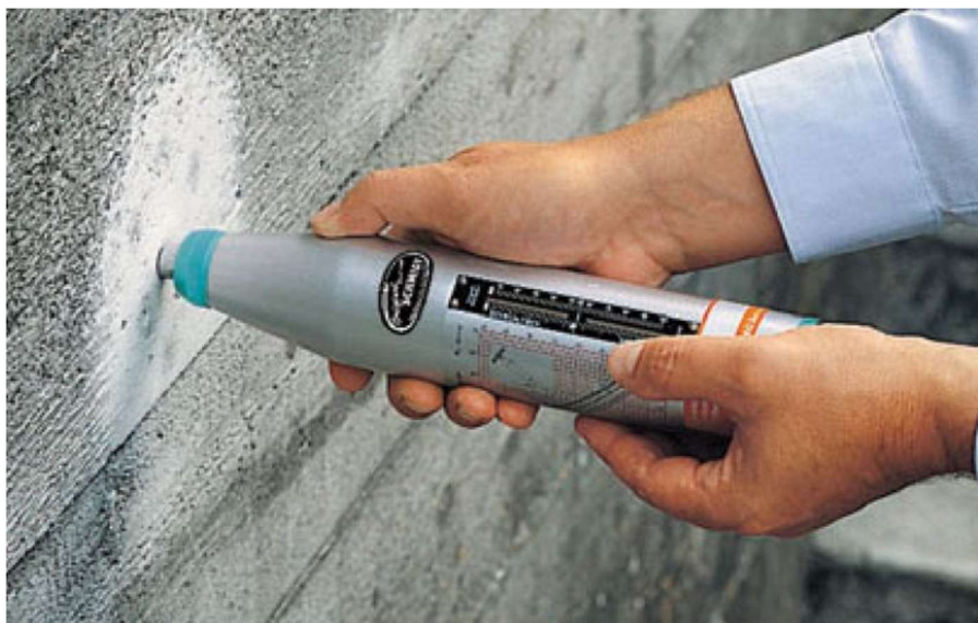
Obrázek 4 Zkouška Schmidtovým tvrdoměrem
