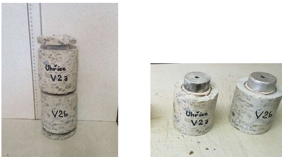
Obrázek 17 Způsob přípravy vzorků ke zkouškám pevnosti v tahu povrchových vrstev betonu a pevnosti betonu v tlaku
