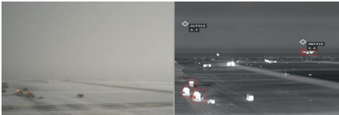
Obrázek č. 4 - vlevo je pohled na letištní plochu za špatné viditelnosti; na pravé straně je stejná scéna, ale vylepšená o infračervené zobrazení. Zdroj: [8]
