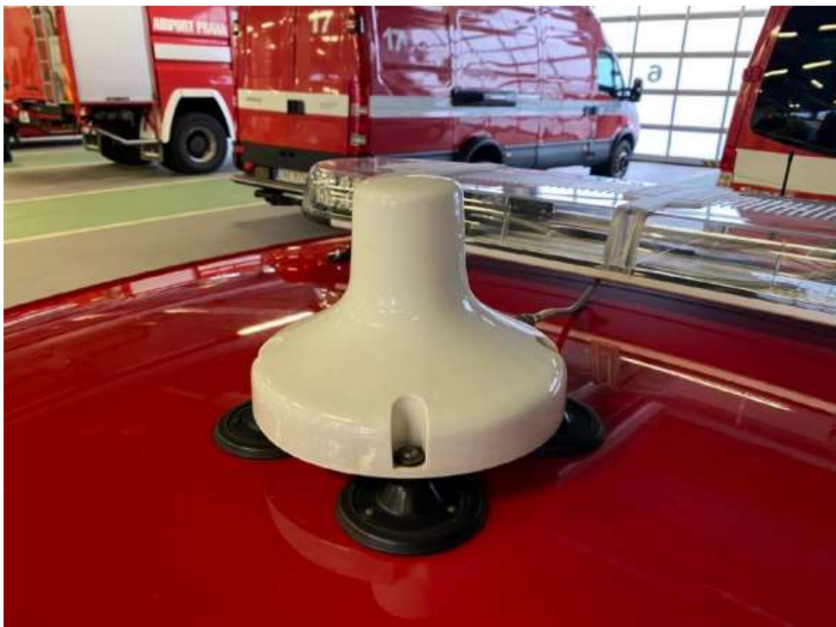
Obrázek 22 – SQUID vysílač na hasičském vozidle HZSP Letiště Praha a.s. [autor]
