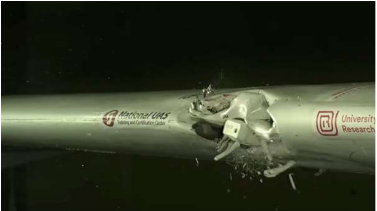
Obrázek 11 – Střet dronu DJI Phantom II s křídlem letounu Mooney [20]
