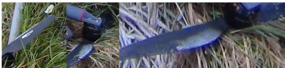
Obrázek 21 Námraza na vrtulích hexakoptéry [29]
