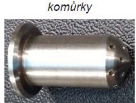
Obr. 1. Konstrukce vyplachované předkomůrky – funkční vzorek
