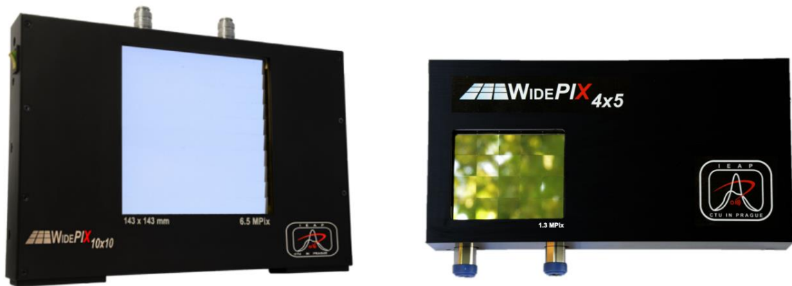
Obr. 18. Velkoplošň detektory WidePIX složené z jednotlivých detektorů Timepix. Vlevo detektor o velikosti 10 x 10 čipů (6,5 megapixelů), vpravo detektor o velikost 4 x 5 čipů (1,3 megapixelů).[33]
