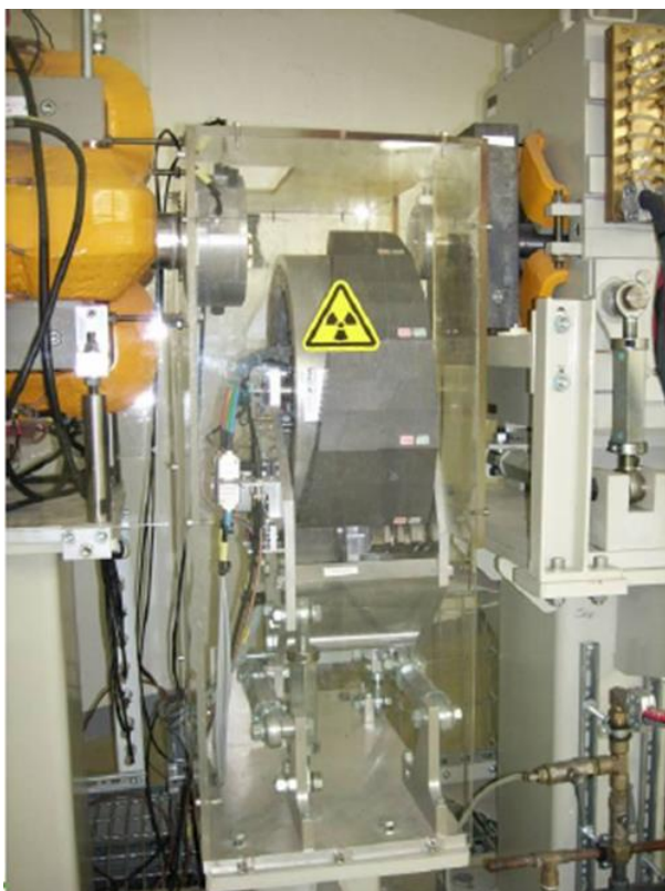
Obr. 3. Degradér slouží ke změně energie terapeutického svazku. Skládá se z grafitu o 154 stupních tloušky a mění energii vstupující do pacienta v rozsahu 100 až 226 MeV.[11]
