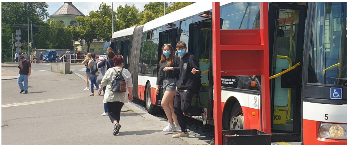
Obrázek 28: Nepřípustný výškový rozdíl na výstupní zastávce G
