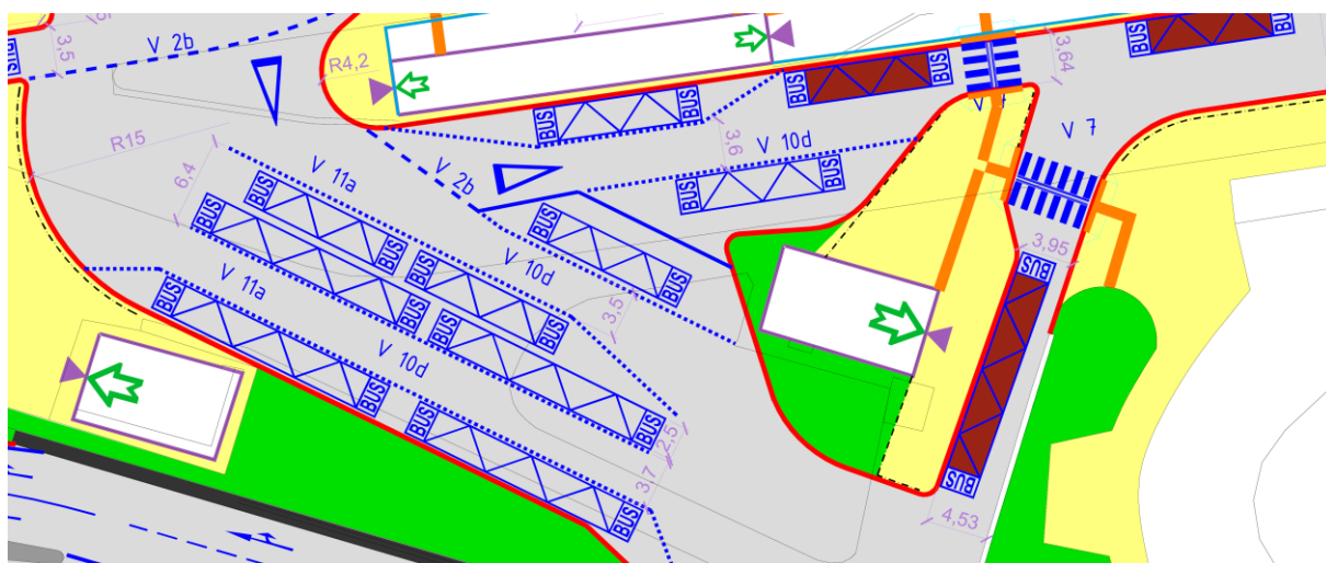
Obrázek 33: Situace odstavných stání pro východní linky (příloha 1.1)
