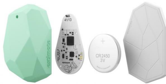
Obrázek 18: Struktura iBeacon od firmy Estimote [14]
