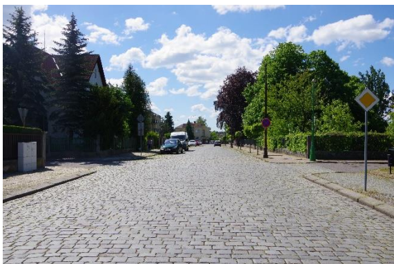
Obr. 19: Úsek č. 22 - Příliš rozlehlá křižovatka, nevhodně umístěné SDZ 40
