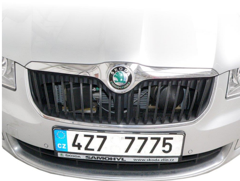
Obrázek 3: Mikrovlnný mobilní radar za maskou vozidla [21]
