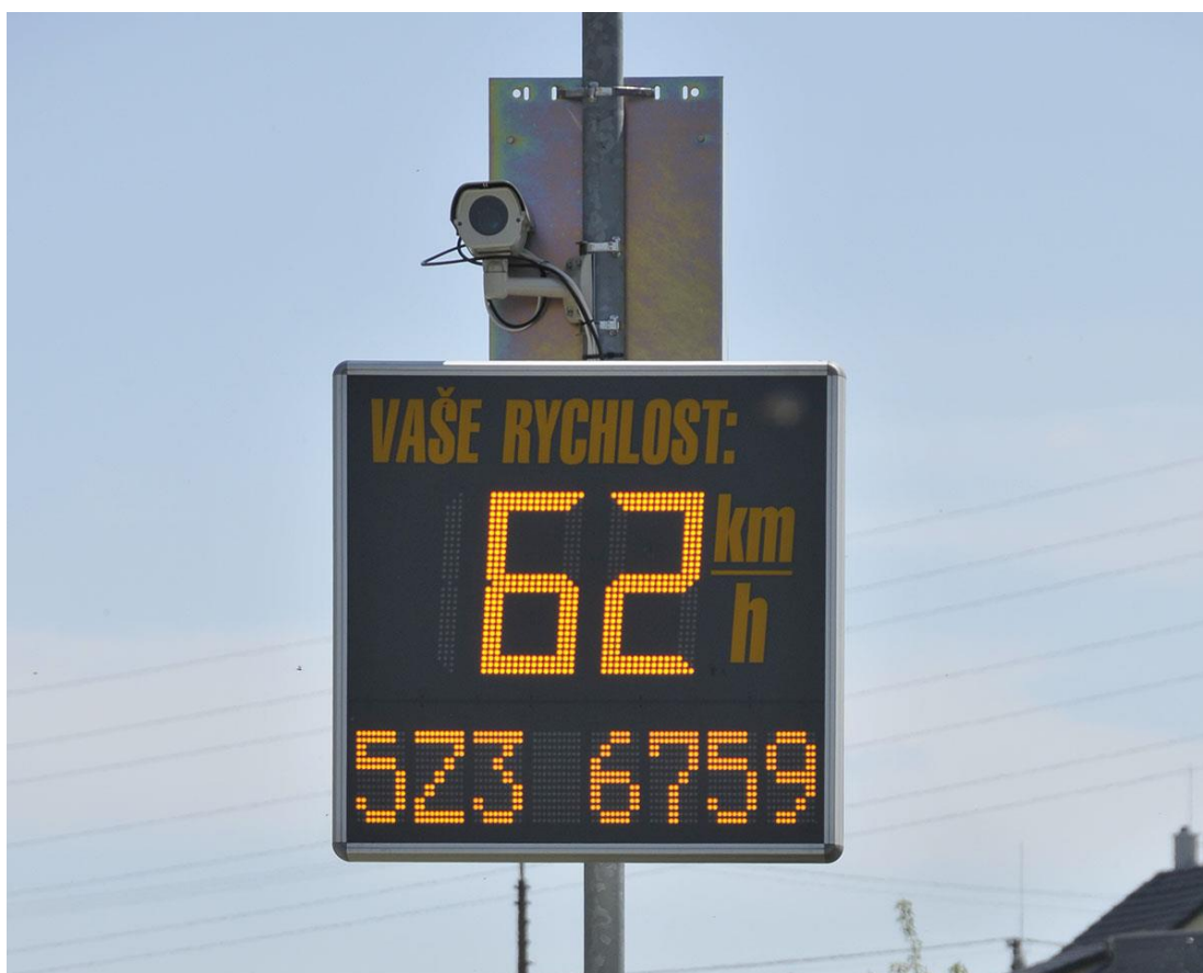
Obrázek 5: Informační radar s kamerou a SPZ měřeného vozidla [24]
