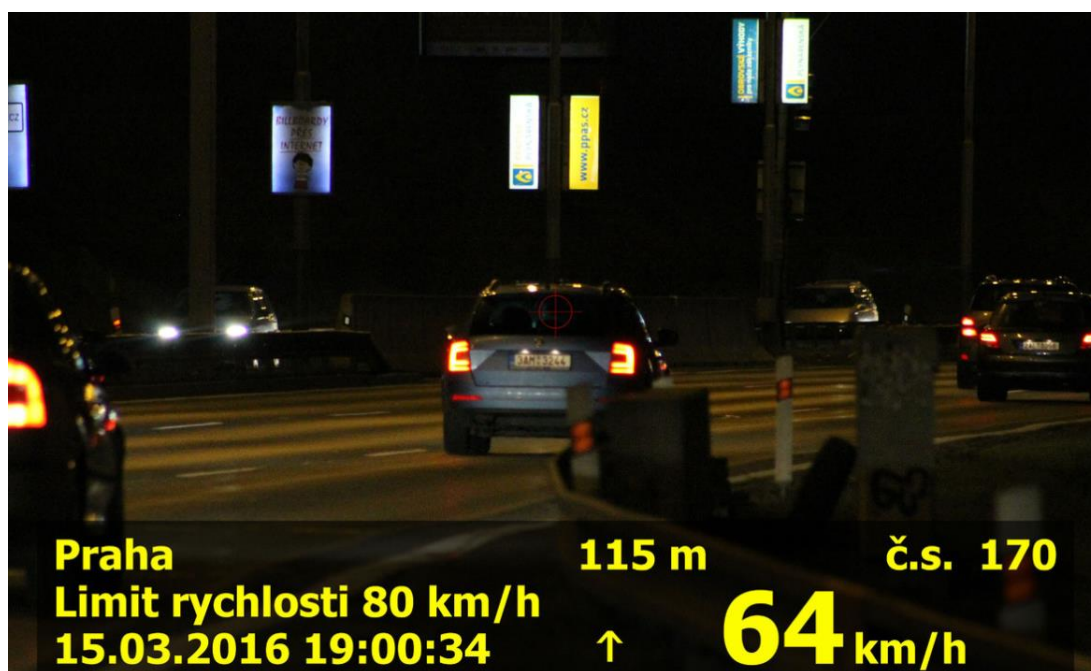
Obrázek 4: Výstup z měření rychlosti laserovým radarem [22]
