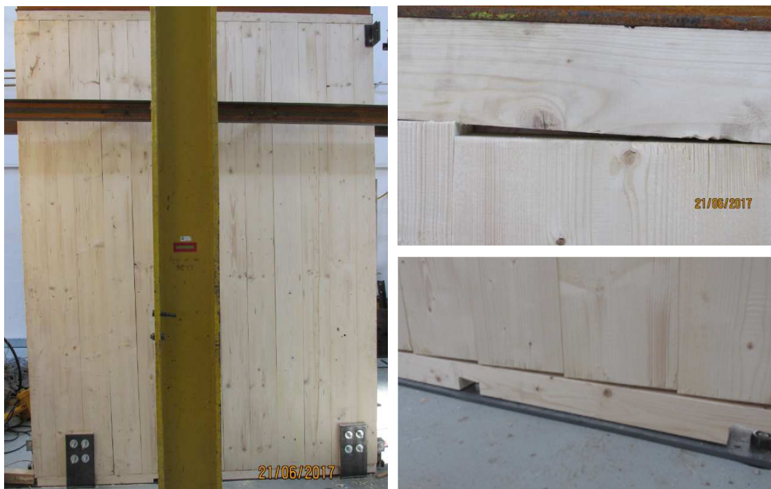
Obr. 39: Deformace v ploše stěnového panelu (vlevo), kontakt svislých lamel s rámovým hranolkem ve vrcholu panelu (vpravo nahoře) a v patě panelu (vpravo dole)
