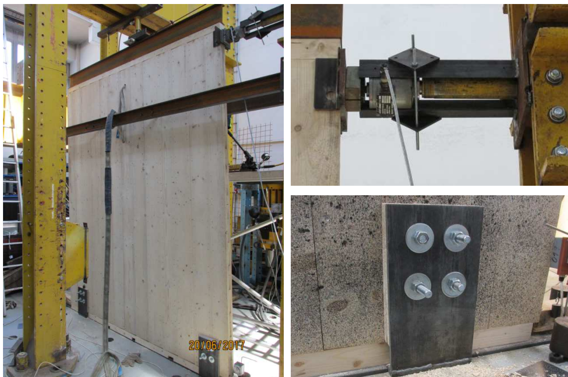
Obr. 33: Osazení zkušebního tělesa v zatěžovacím rámu (vlevo), vnášení vodorovné síly (vpravo nahoře), kotvení stěny k podkladu (vpravo dole)
