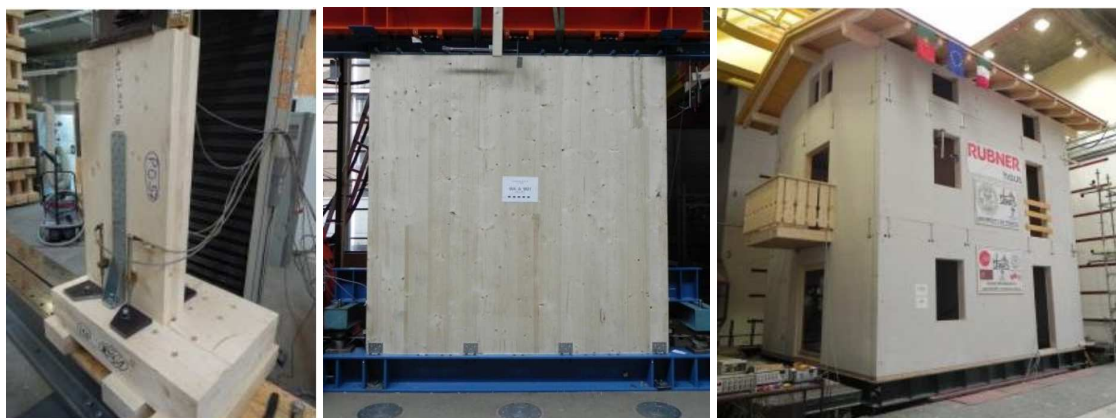
Obr. 20: Zkoušky samostatných spojů (vlevo), zkoušky výztužných stěn (uprostřed) a zkouška mechanické odolnosti objektu (vpravo) [32]
