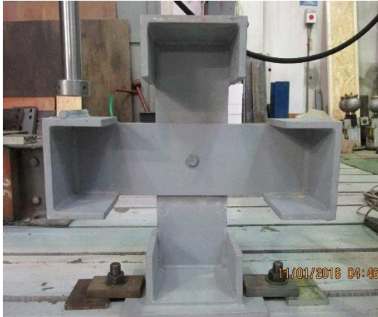
Obr. 44: Zkušební přípravek (vlevo) a vzorek s osazenými snímači umístěný ve zkušebním přípravku (vpravo)
