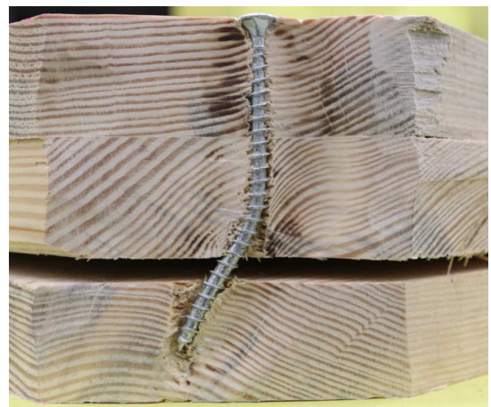
Obr. 48: Demontovaný zkušební vzorek (vlevo) a porušení spojovacího prostředku (vpravo)
