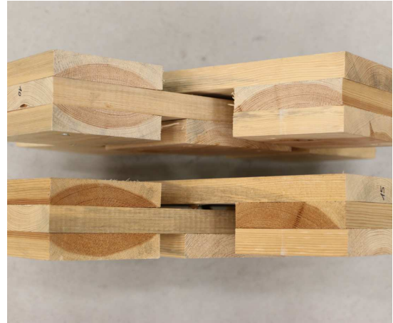
Obr. 47: Příklad porušení zkušebních vzorků série A a B
