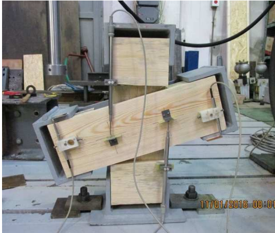
Obr. 47: Příklad porušení zkušebních vzorků série A a B
