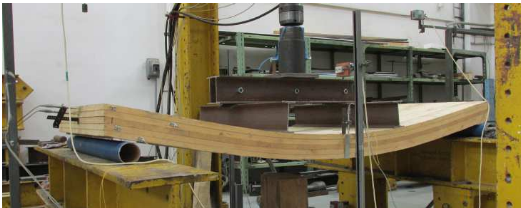
Obr. 29: Průběh čtyřbodové ohybové zkoušky stropního panelu
