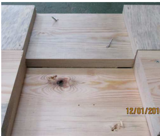
Obr. 48: Demontovaný zkušební vzorek (vlevo) a porušení spojovacího prostředku (vpravo)
