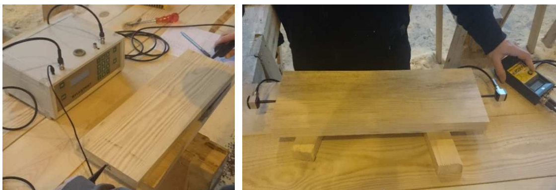
Obr. 64: Měření modulu pružnosti lamel přístroji Sylvatest (vlevo) a Fakopp (vpravo)
