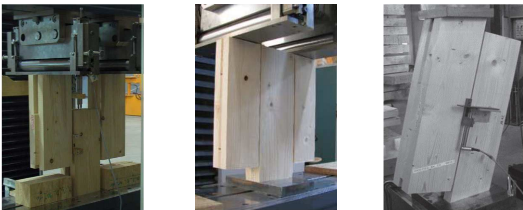
Obr. 14: Uspořádání zkoušek samostatných uzlů pro určení pevnosti a tuhosti ve smyku vrstvy: Wallner [19] (vlevo), Jöbstl et al. [20] (uprostřed) a Hirschmann [21] (vpravo)
