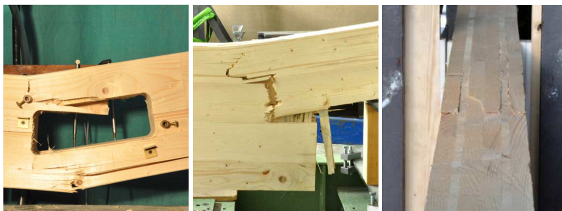
Obr. 17: Příklady porušení nosníků z lepeného CLT [27]
