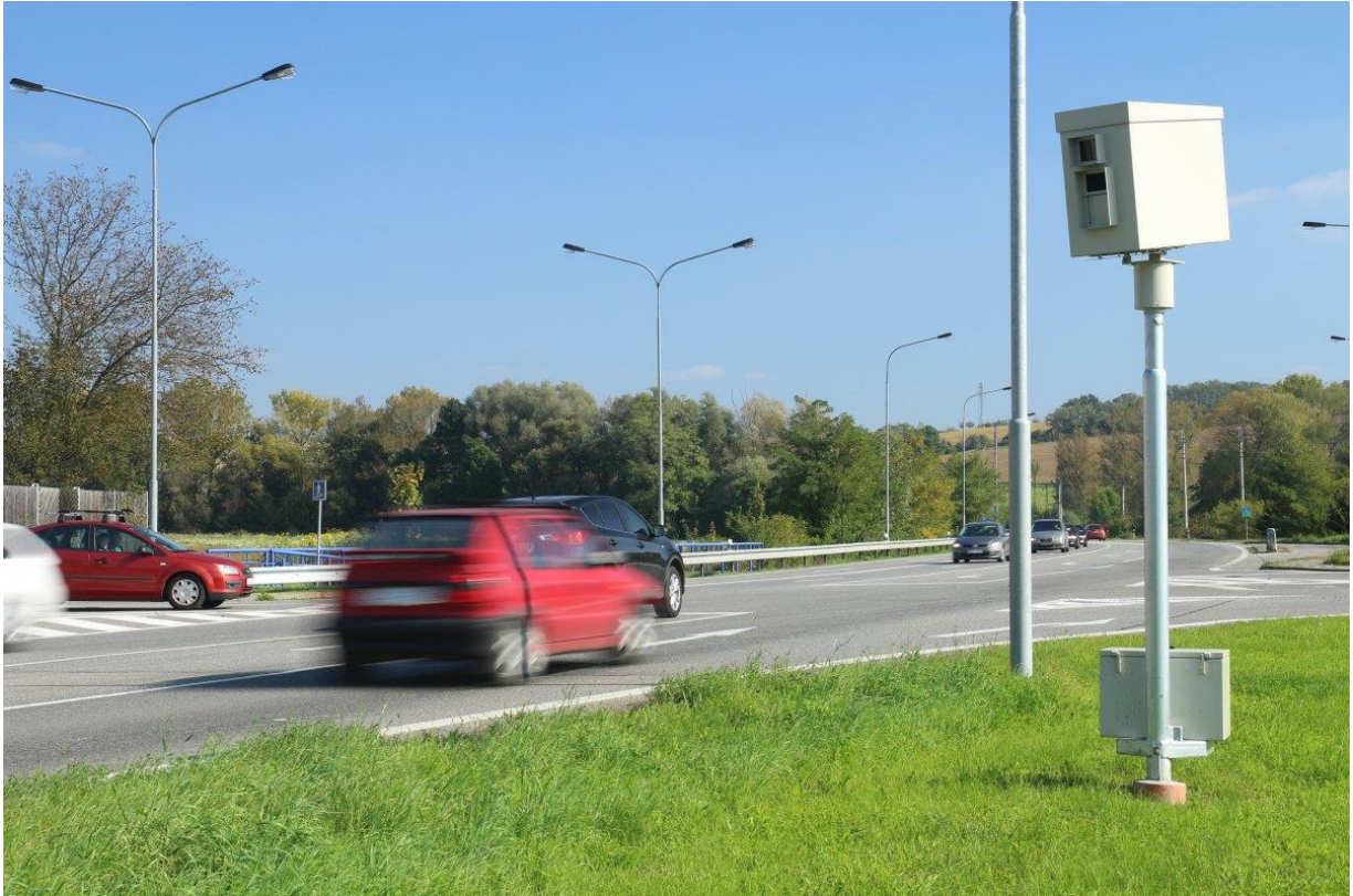
Obrázok 8. Stacionárny radarový merač rýchlosti RAMER10P. Zdroj: https://www.ramet.as/ramer10-p-1419322652
