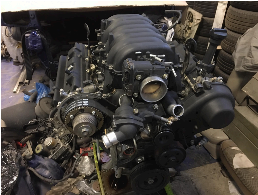
Obr. 50.: Pohled na viditelné VVT-i členy motoru 3UZ-FE [Zdroj: Autor]
