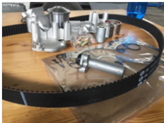
Obr. 45.: Sada ozubeného řemene včetně vodního čerpadla, kladek a napínáku pro motor 3UZ-FE [Zdroj: Autor]
