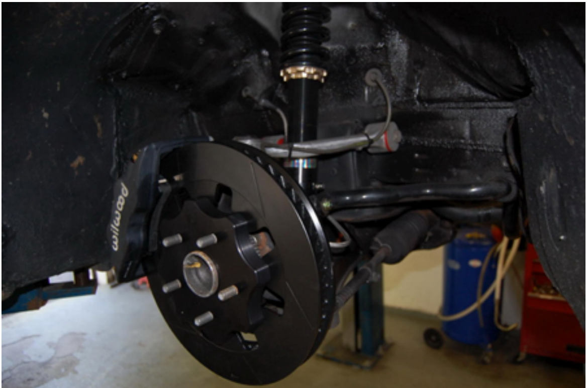
Obr. 7.: Modifikovaná technika náprav vozidla Toyota Supra MA70 [Zdroj: Autor]
