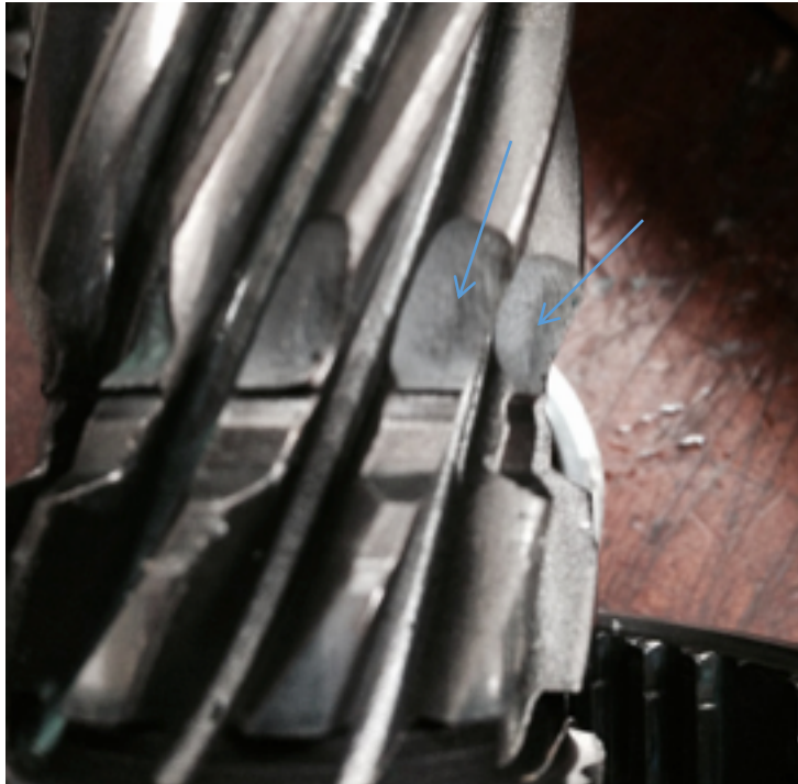
Obr. 28.: Důsledky konstrukční vady u převodovky J160 [Zdroj: Autor]
