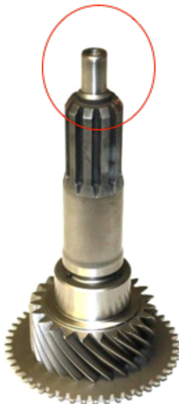
Obr. 33.: Vstupní hřídel převodovky G-53BZ, značené dle BMW S6 [Zdroj: [5]]
