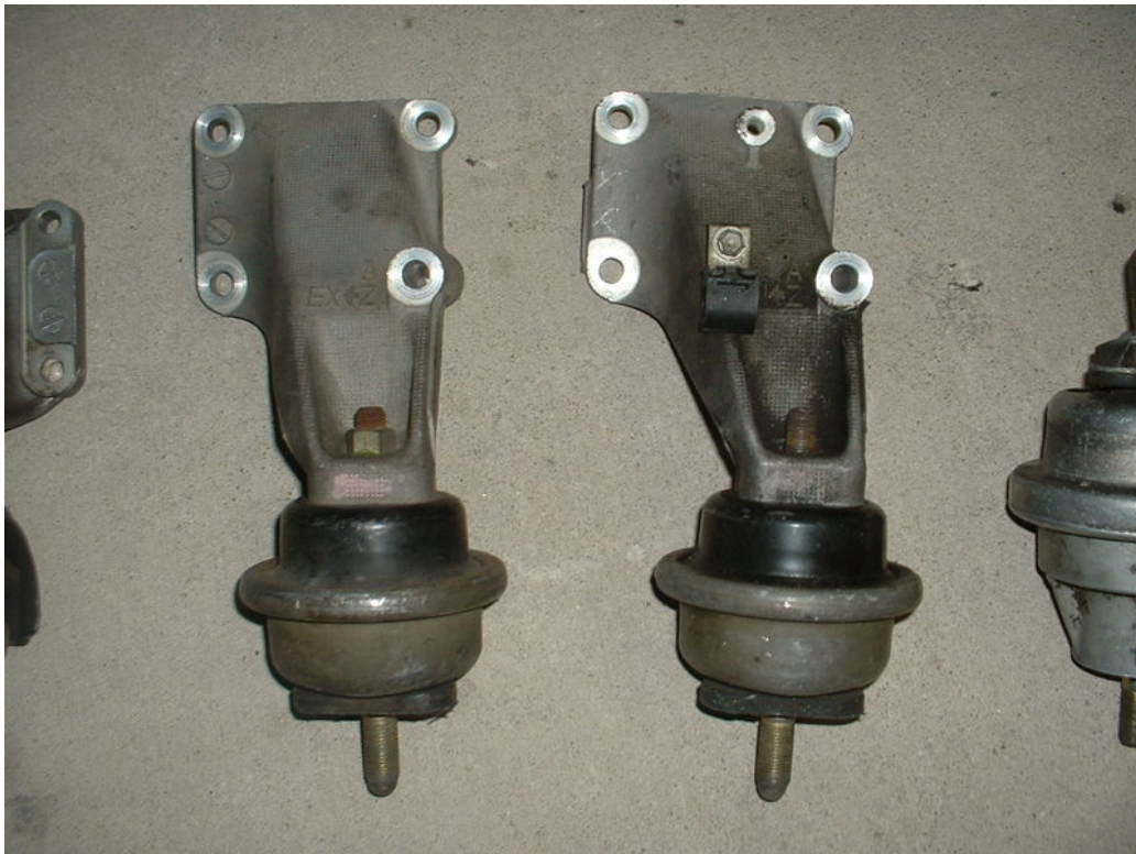
Obr. 52.: Původní uložení motoru pro 3UZ-FE motor z vozidla Lexus GS430 [Zdroj: [7]]
