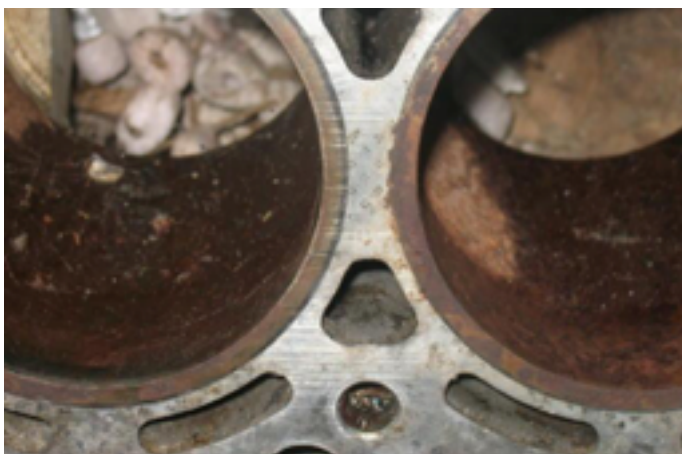
Obr. 42.: Vzdálenost mezi vložkami válců v bloku motoru 1UZ-FE [Zdroj: [7]]
