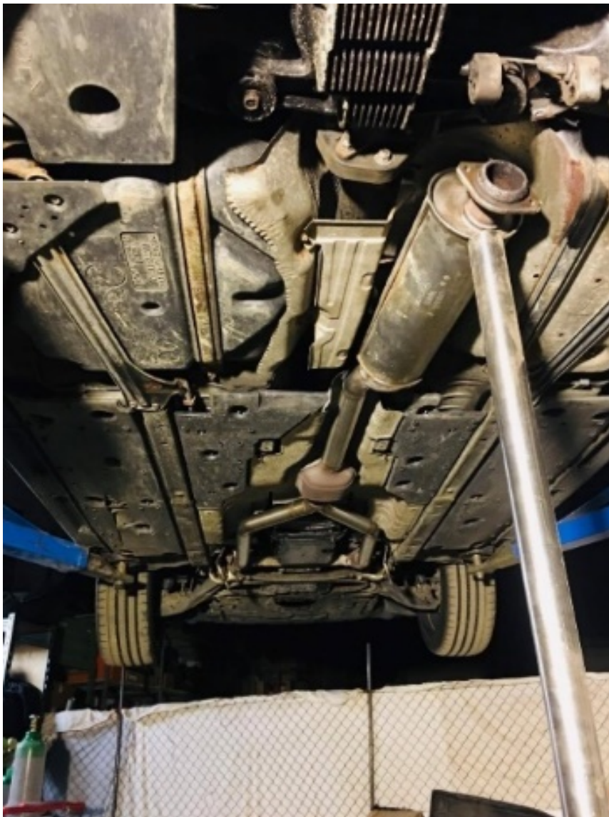
Obr. 71.: Upravené potrubí (vyrobené podle předlohy) pro vozidlo Toyota Supra MA70 po přestavbě [Zdroj: Autor]
