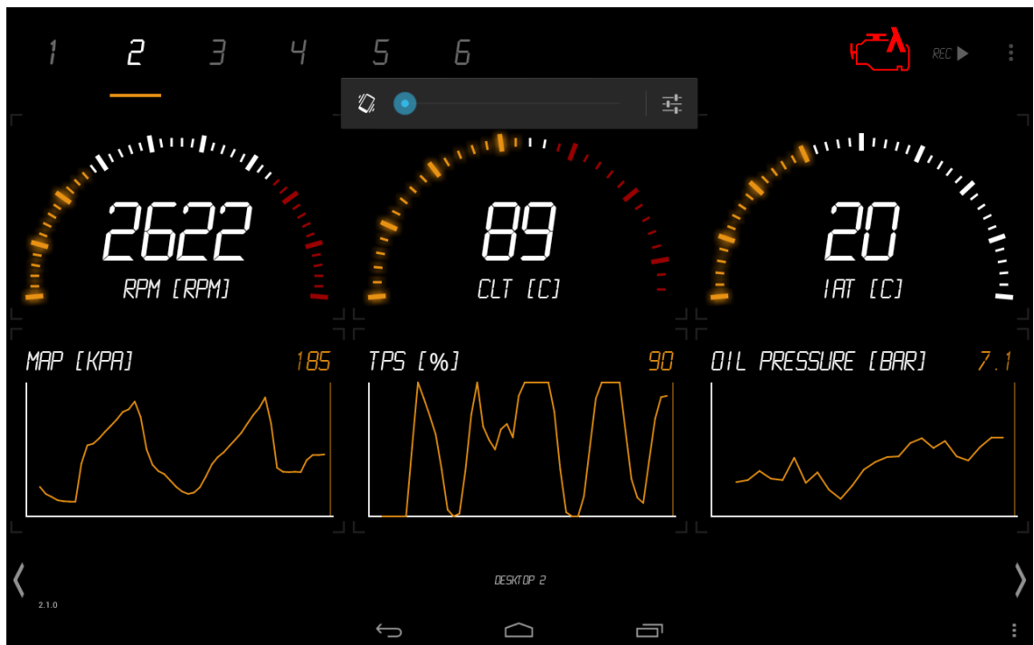
Obr. 75.: Ecumaster Dashboard software pro zobrazení výstupních veličin motoru 3UZ-FE [Zdroj: [18]]
