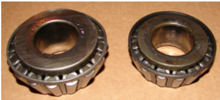
Obr. 25.: Modifikované kuželíkové ložisko (na levé straně modifikovaná verze a po roce 1989 a na pravé straně původní ložisko) [Zdroj: [7]]
