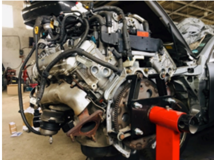
Obr. 44.: Motor 3UZ-FE uchycený ve stojanu z vozidla Lexus GS430 [Zdroj: Autor]
