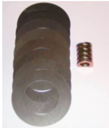
Obr. 24.: Sada na generální opravu lamelového diferenciálu z vozidla Toyota Supra obsahující nové lamely a pružinu [Zdroj: [2]]
