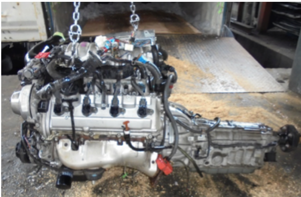
Obr. 38.: Poslední revize 1UZ-FE, opticky naprosto totožná s 3UZ-FE [Zdroj: [7]]
