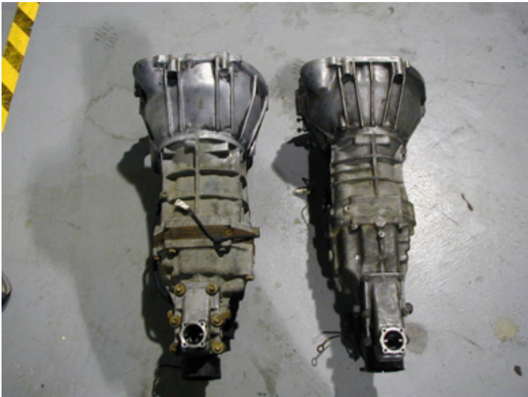
Obr. 20.: Přímé srovnání převodovek z Toyota Supra W58 a R154 [Zdroj: Autor]
