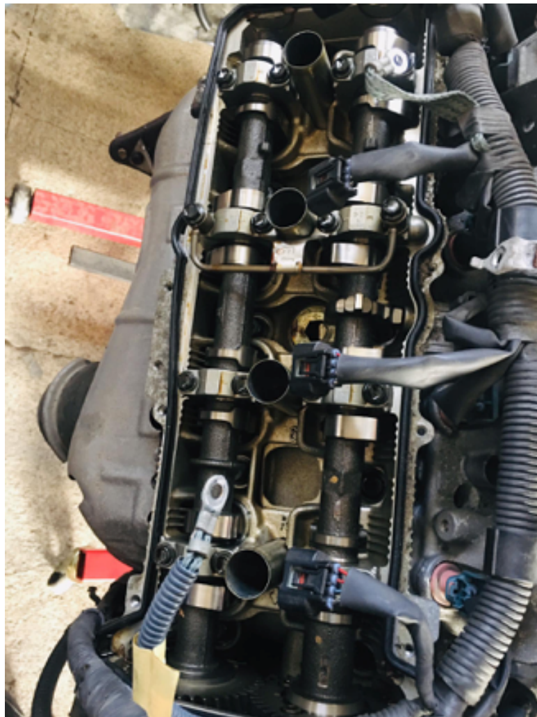
Obr. 46.: Vačkové hřídele na motoru 3UZ-FE po měření ventilové vůle [Zdroj: Autor]
