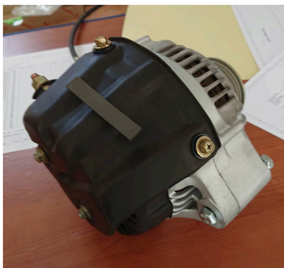
Obr. 49.: Kompletně repasovaný alternátor z motoru 3UZ-FE použitým ve voze Lexus GS430
