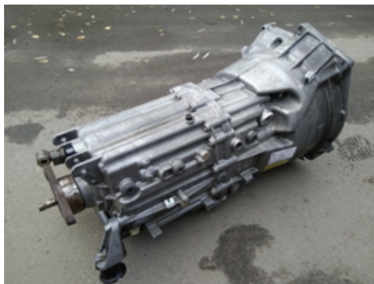
Obr. 32.: Použitá převodovka z BMW 330d, GS6-53DZ [Zdroj: Autor]
