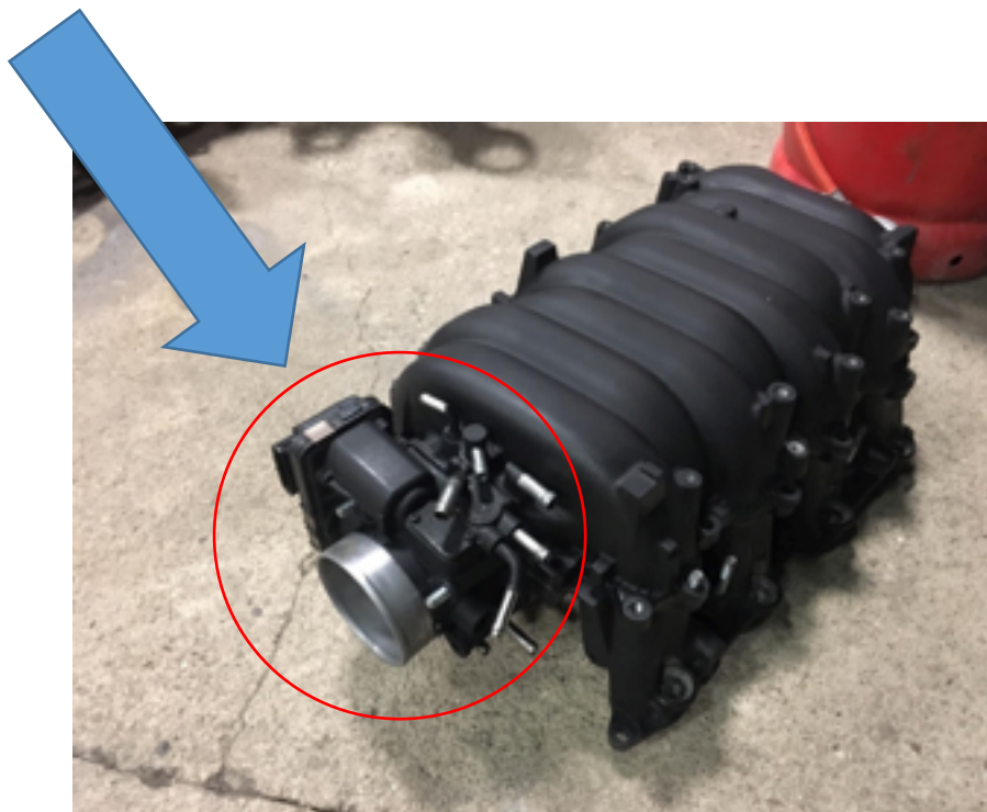
Obr. 47.: Sání motoru, vyčištěné a nalakované s instalovanou klapkou z motoru 3UZ-FE
