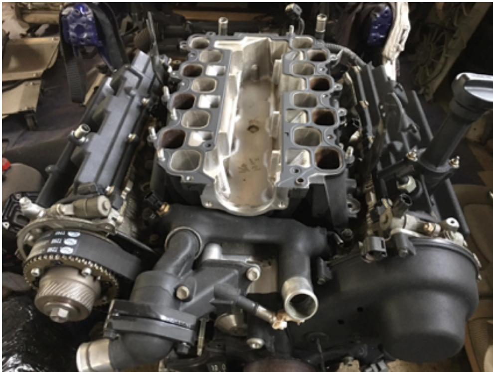
Obr. 48.: Pohled na nové těsnění pro sání motoru 3UZ-FE
