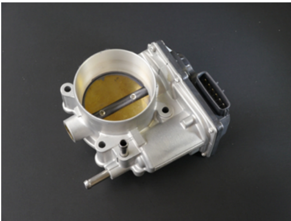
Obr. 39.: Elektronická škrticí klapka [Zdroj: [7]]
