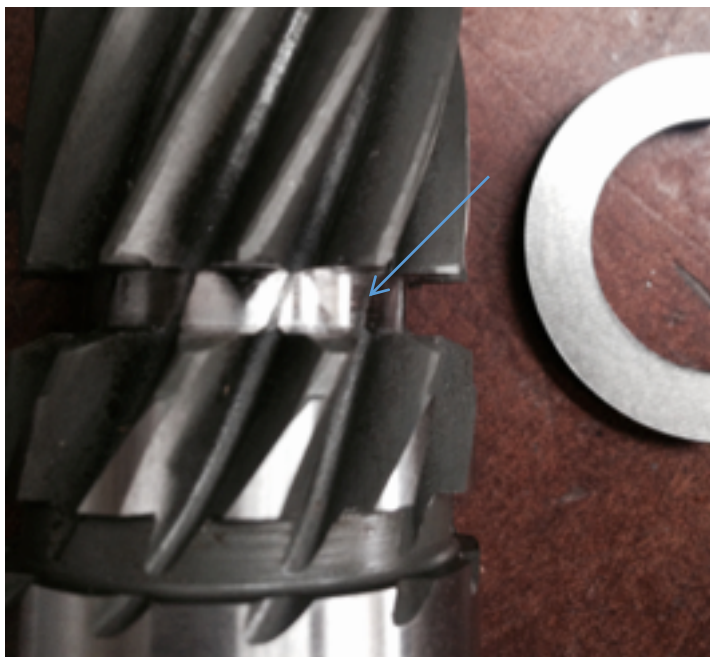
Obr. 29.: Nutná modifikace hřídele pro možnost instalace zesíleného pojistného kroužku u převodovky J160 [Zdroj: Autor]
