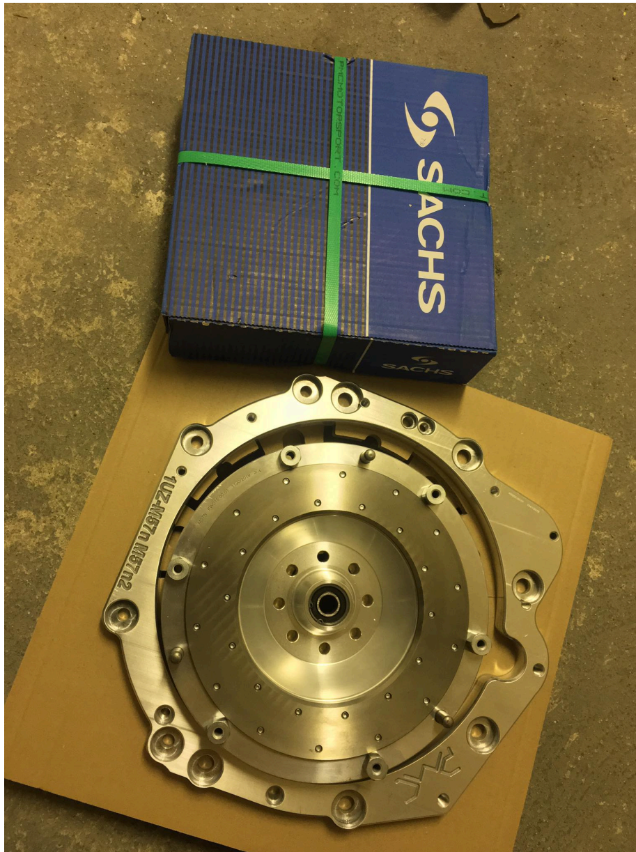
Obr. 64.: Setrvačnick včetně redukční příruby a spojkové sady pro alternativní osazení motoru 3UZ-FE převodovkou GS6-53BZ [Zdroj: Autor]
