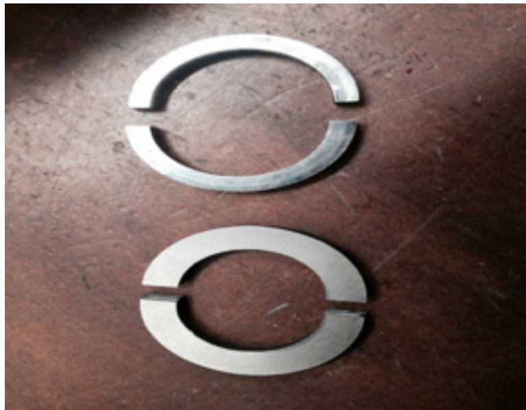
Obr. 27.: Porovnání rozměrů pojistného kroužku před a po modifikaci u převodovky J160 [Zdroj: Autor]
