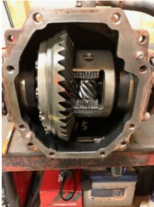
Obr. 23.: Samosvorný diferenciál použitý ve vozidle Toyota Supra JZA70 [Zdroj: [2]]
