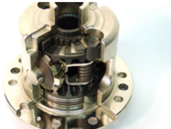
Obr. 22.: Lamelový samosvorný diferenciál ve vozidle Toyota Supra MA70 [Zdroj: [4]]
