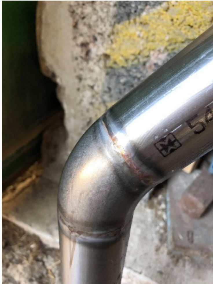
Obr. 72.: Výstup k tlumiči výfuku vyrobený dle předlohy pro vozidlo Toyota Supra MA70 po přestavbě [Zdroj: Autor]
