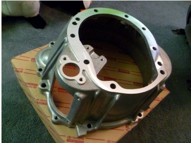
Obr. 60.: Zvon pro převodovku R154 z vozidla Toyota Supra MA70 [Zdroj: Autor]
