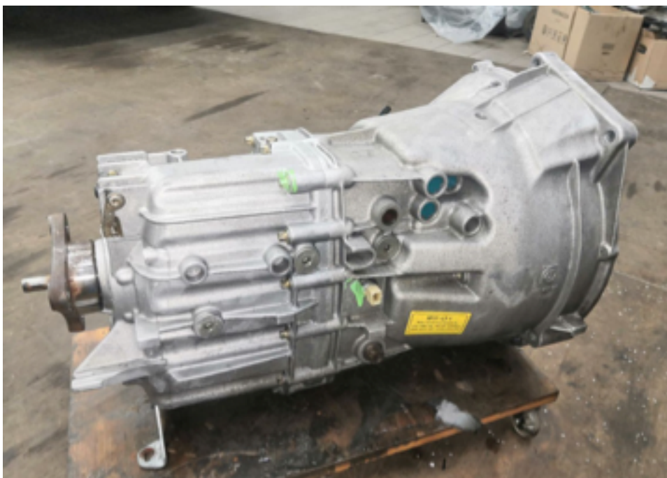
Obr. 34.: Převodovka z BMW 330d, GS5-53DZ [Zdroj: Autor]
