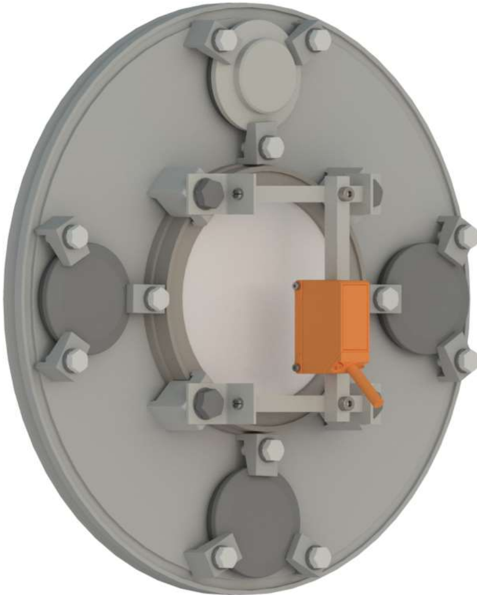
Obrázek 32- Připevnění měřícího přípravku k přírubě
