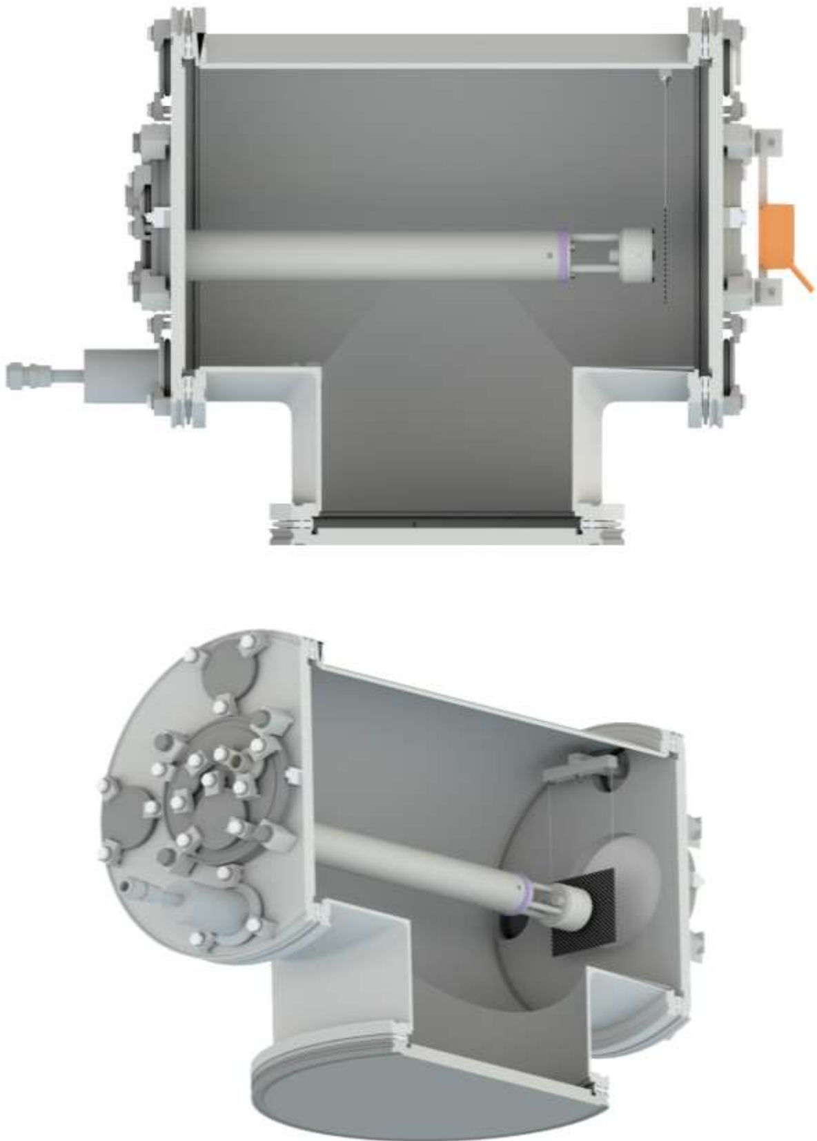
Obrázek 28 - Uspořádání testovacího přípravku ve vakuové komoře
