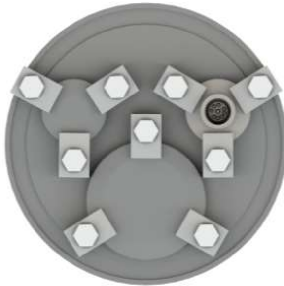
Obrázek 26 - Upevnění přírub na přírubu DN 100 ISO-K
