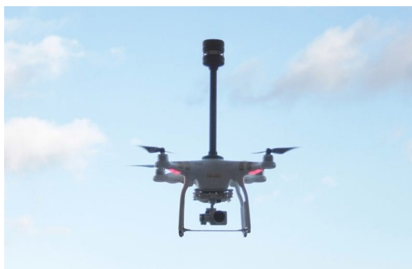
Obrázek 3 - DJI Phantom s anemometrem [10]
