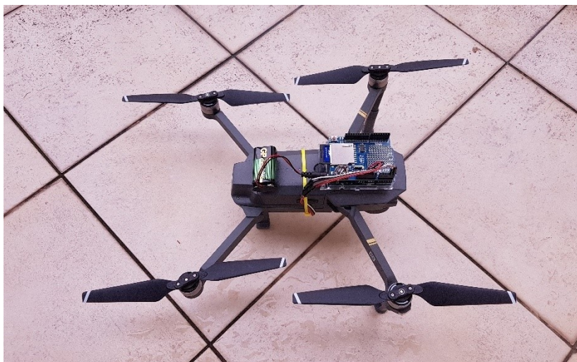
Obrázek 19 - DJI Mavic Pro s měřicím modulem [autor práce]
