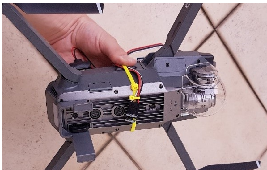
Obrázek 20 - Umístění měřicích senzorů pod tělem multikoptéry [autor práce]
