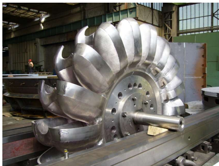
Obrázek 13 - Oběžné kolo Peltonovy turbíny [12]
