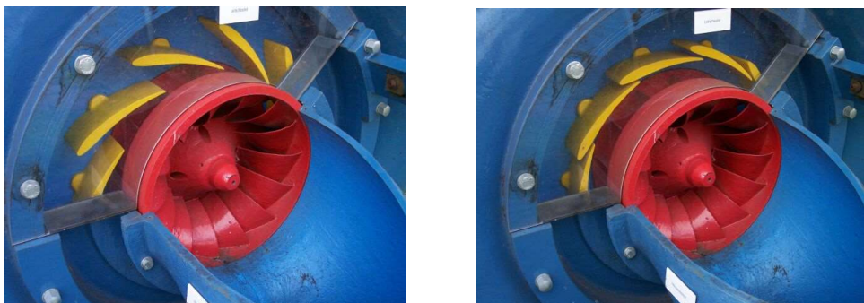
Obrázek 8 - Natáčivé lopatky rozvodného kola malé Francisovy turbíny [9]
