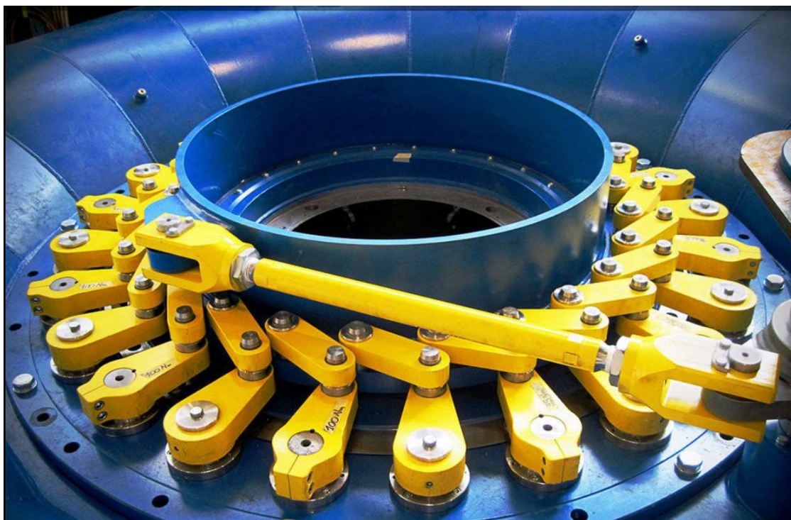
Obrázek 9 - Otočný prstenec rozvodného kola Francisovy turbíny [10]
